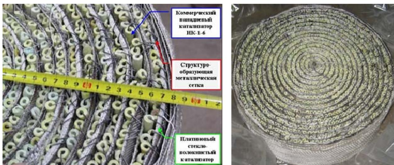
**Рис. 4.3. Структура и внешний вид комбинированного каталитического картриджа разработанного и созданного нами для пилотной установки.**
