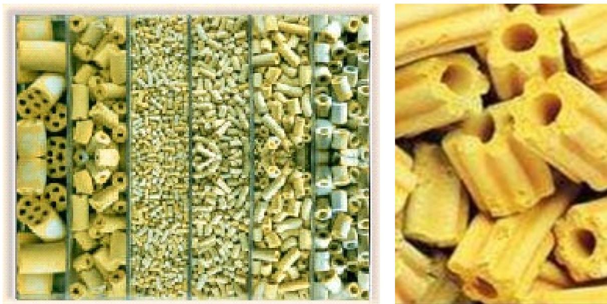
**Рис. 1.10. Разновидности ванадиевых катализаторов.**
