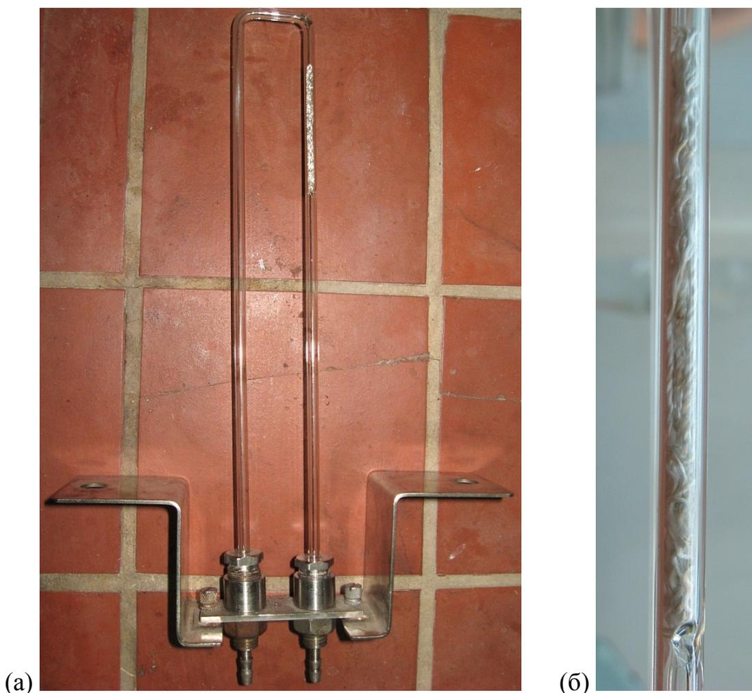
**Рис. 2.3. Внешний вид лабораторного реактора (а) и реакционной зоны с нитками стекловолокнистого катализатора (б).**
