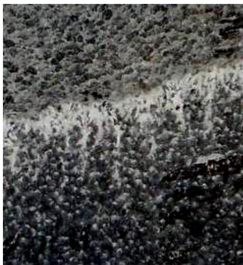
Рис. 3.19 – Снимок боковой поверхности слоя гранул при осаждении дисперсных частиц вельцоокси
