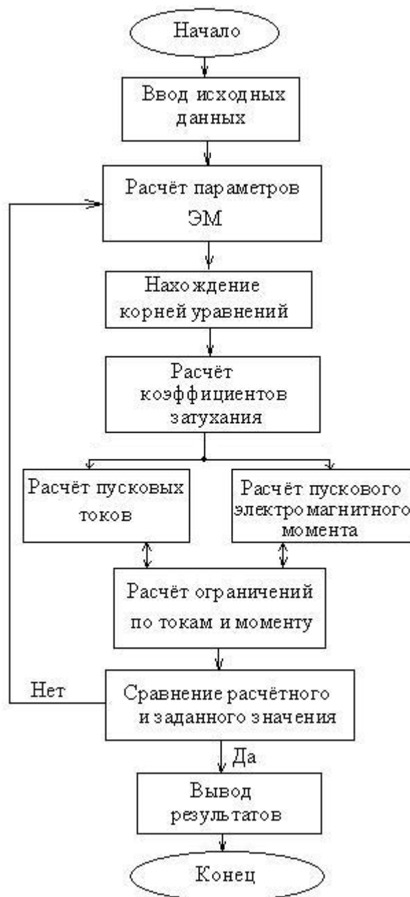
Рис. 2.2. Алгоритм расчёта МДП при колебательном режиме работы
