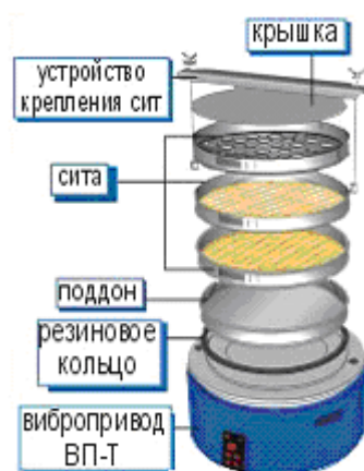
Рис. 1.3. Анализатор для сухого отсева сыпучих материалов по крупности частиц в периодическом режиме
