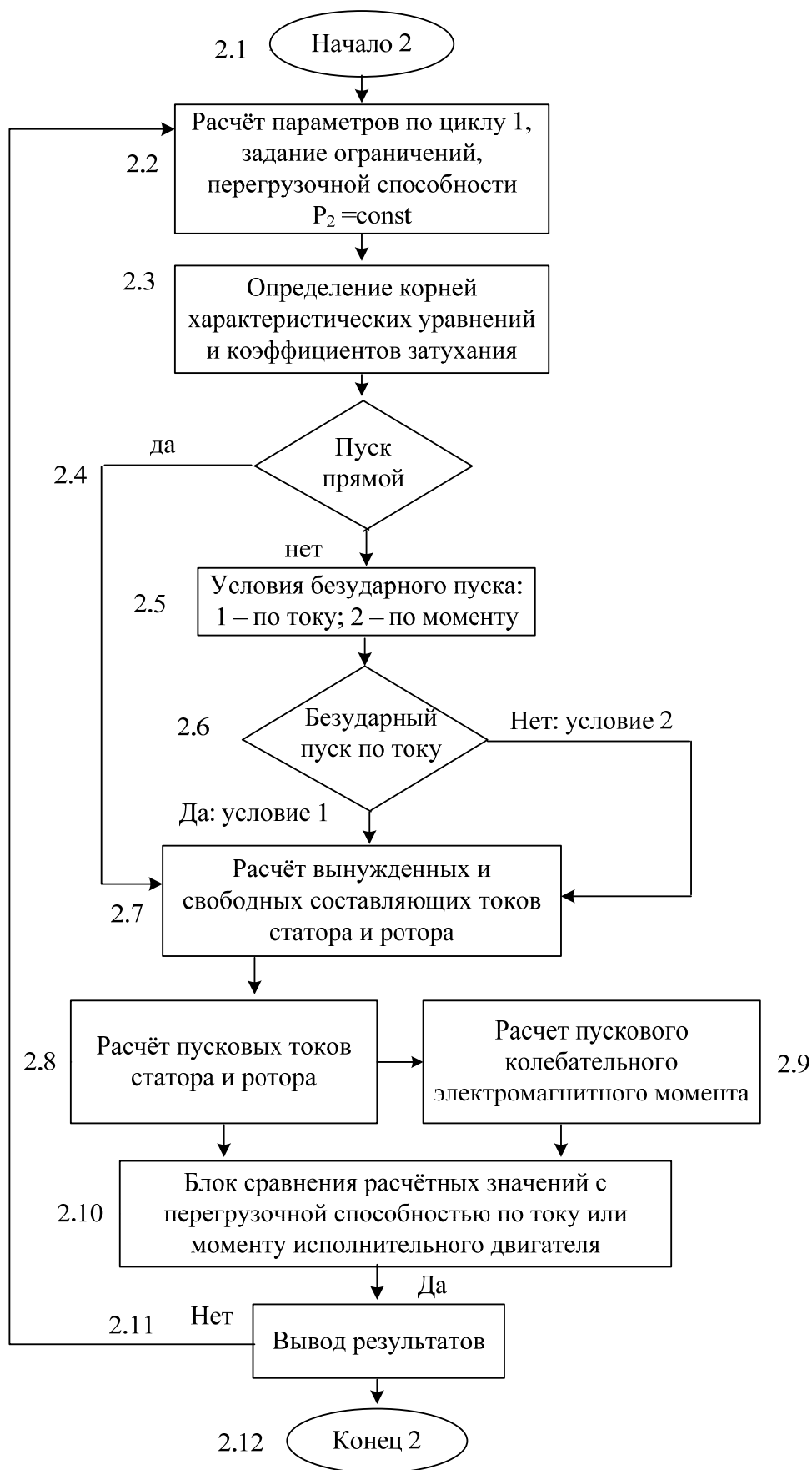
Рис. 2. 16. Алгоритм расчёта ударных значений токов статора и ротора и электромагнитного момента в зависимости от её геометрии
