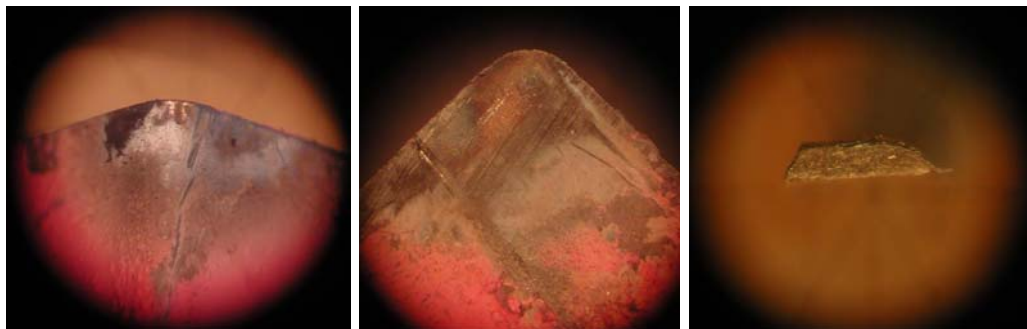
Рис.4.16 Результаты цветового перехода термокраски ТИК №14 ТУ 6-09-79-76 T_{пер} = 570^{\circ}C и поперечное сечение стружки при точении стали 45 обрабатываемый материал Т5К10, геометрия \varphi=45^{\circ} \gamma=0^{\circ} , \alpha=10^{\circ} , r=0,8mm при условиях V=160 м/мин; t=1,3 мм; S=0,39 мм/об.
