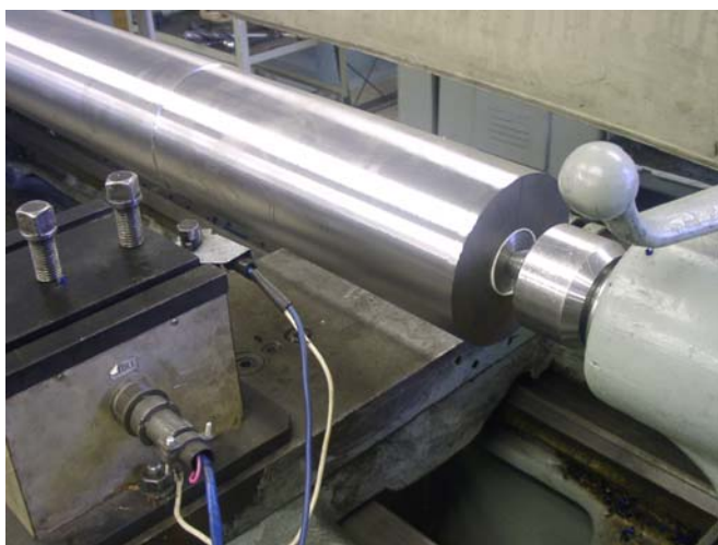
Рис. 4.5 Изоляция заготовки во вращающемся центре и токосъемник
