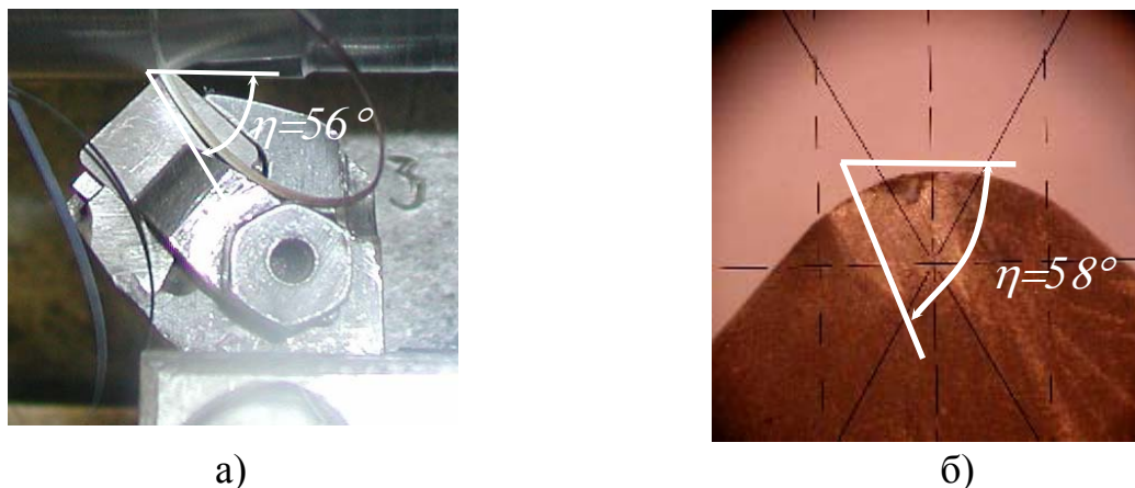
Рис.4.7 Результаты измерения направления схода стружки:
