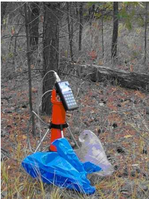
Рис.14. Полевые гамма-спектрометрические измерения с применением МКС АТ6101Д в районе ПЯВ «Кратон-4».
