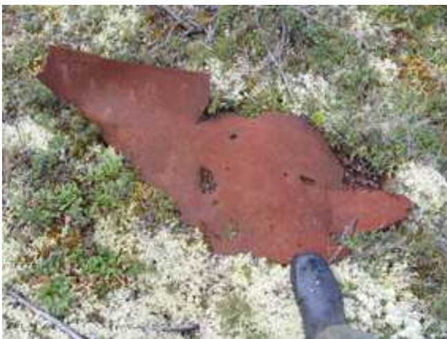
Рис. 52. Конструкция боевой скважины «Кратон-3» на момент взрыва. Голубым показано наполнение ствола скважины водой, красной штрих-линией – зона тектонического разлома (а), фрагменты разлетевшихся конструкций боевой скважины в 300 м к югу от устья, фото Артамоновой, 2008 г.(б)
