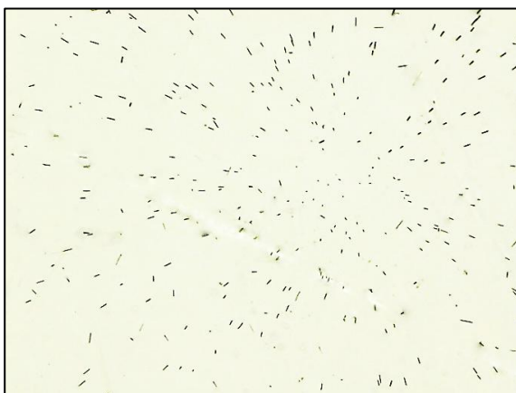
Рисунок 5.2.6 – Формы нахождения делящихся радионуклидов (U) в листе тополя, произраставшего вблизи Ульбинского металлургического завода по данным f-радиографии : а – микровключения собственных минералов урана, увел. 50; б – молекулярная форма неструктурного рассеяния, увел. 200
