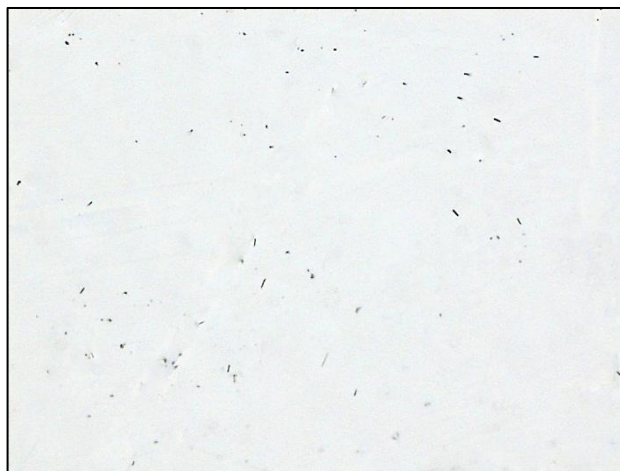
Рисунок 5.2.8 – Распределение треков от осколков деления урана в пробе, отобранной на расстоянии 7 км от Ульбинского металлургического завода, увел. 200
