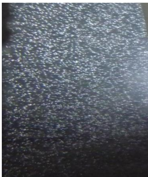
Рисунок 9. Фотография микропузырьковой среды, образующейся в гидродинамическом генераторе
