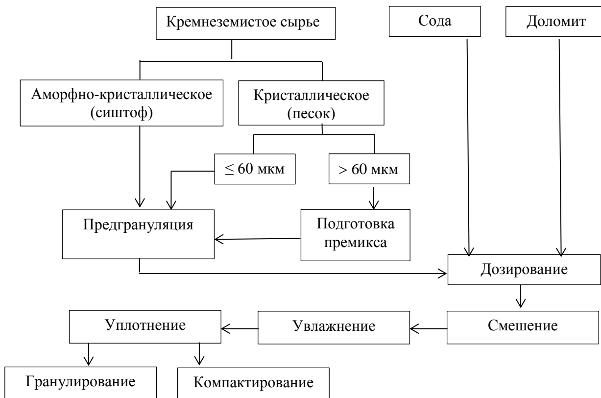
Рисунок 4.26 – Схема приготовления сырьевой шихты на основе стекольных, строительных песков и сиштофа
