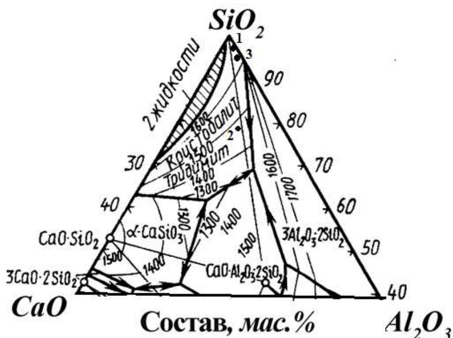
Рисунок 3.3 – Расположение составов исследуемых песков на диаграмме состояния \text{Al}_2\text{O}_3 - \text{CaO} - \text{SiO}_2
