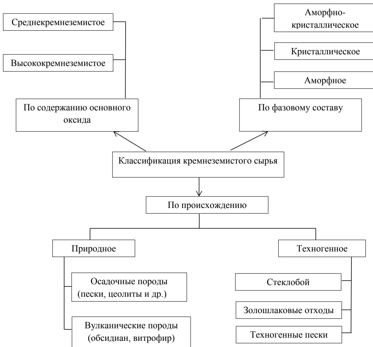
Рисунок 1.3 – Классификация кремнеземистого сырья для получения пеностекляных материалов
