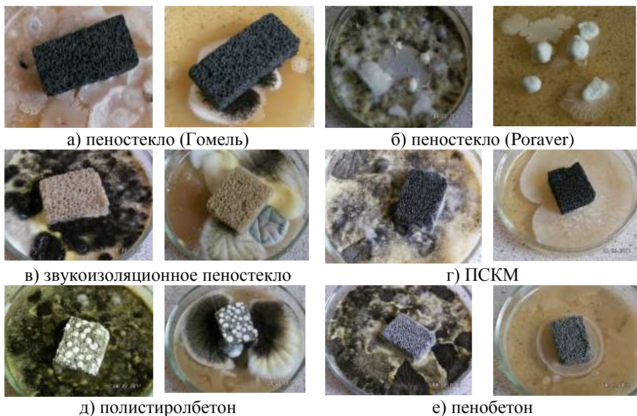
Рисунок 5.2 – Фотографии образцов пеноматериала после инкубации в среде с культурой (слева) и в среде без культуры (справа)
