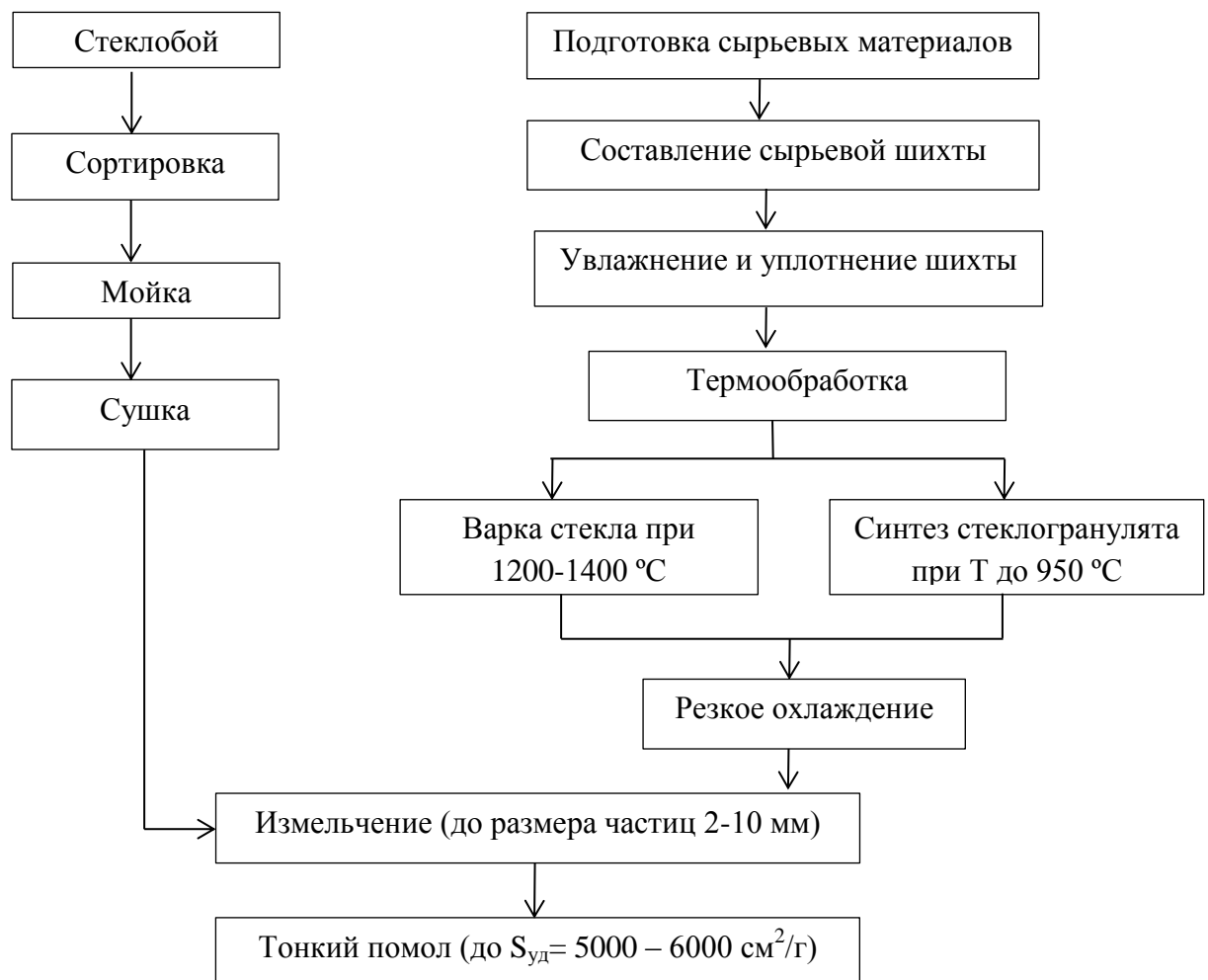
Рисунок 1.5 – Схема получения стеклопорошка
