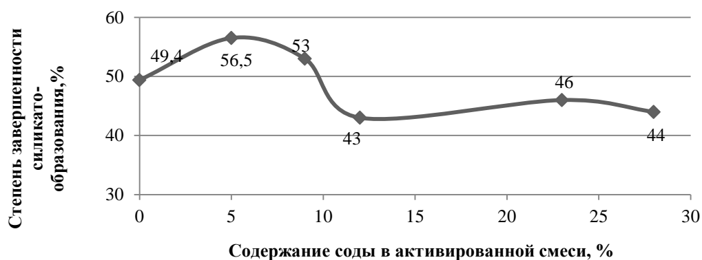
Рисунок 4.23 – Зависимость степени завершения силикатообразования при 700 °С от количества соды в премиксе
