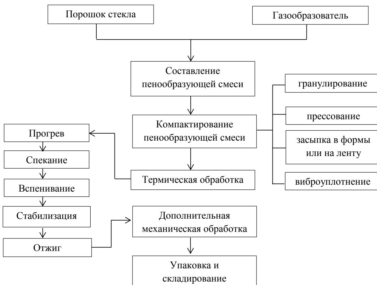
Рисунок 1.4 – Схема производства пеностекольных материалов по порошковому способу
