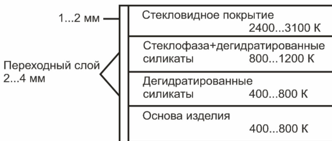
Рисунок 6.1 – Схема распределения температурных полей в глубь изделия
