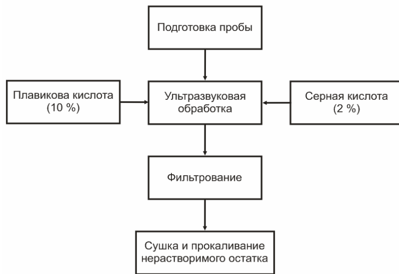
Рисунок 2.3 – Схема количественного определения кристаллической фазы в стеклокристаллическом продукте
