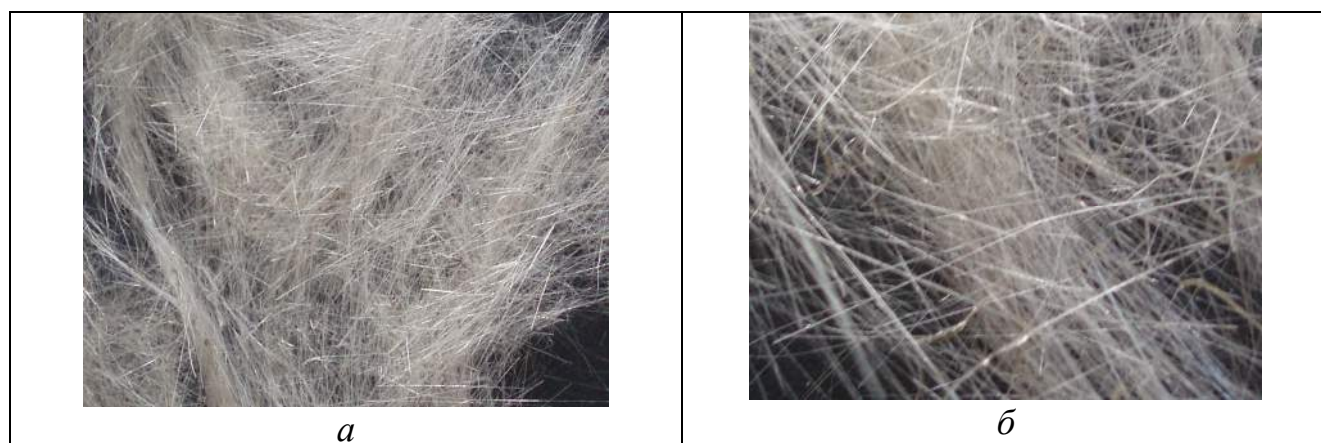
Рисунок 6.4 – Микрофотографии минеральных волокон ( \times 300 ) из: a – золошлаковых отходов, d = 9 мкм; б – продуктов сжигания сланцев, d = 11 мкм
