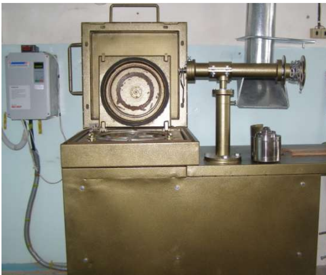
Рисунок 2.7 – Мельница планетарная с водяным охлаждением АГО-3.
