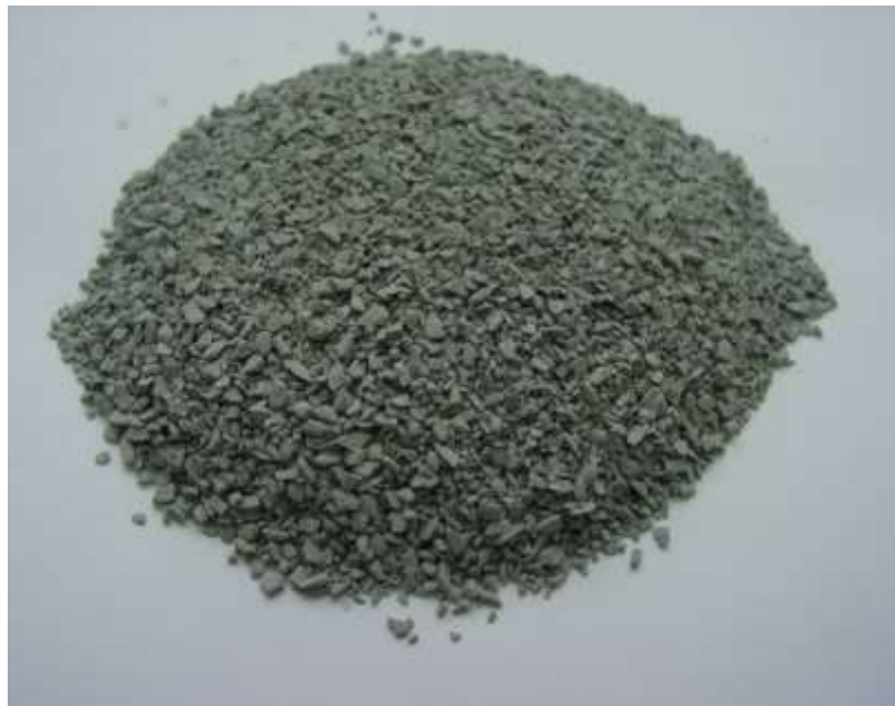
Рисунок 4.3 – Продукт дробления железосодержащего композита на сиалоновой матрице с размером 0,63–2,5 мм.
