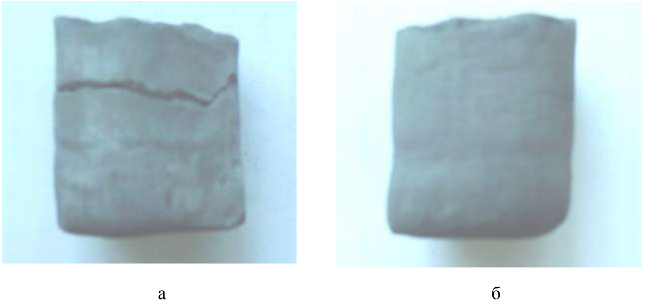
Рисунок 3.10 – Фотографии продукта горения ферросиликоалюминия в азоте с разбавлением конечным продуктом в количестве: а – 5 мас.%, б – 25 мас.%, P_{N_2} = 4\text{Мпа} , d = 40\text{ мм} .
