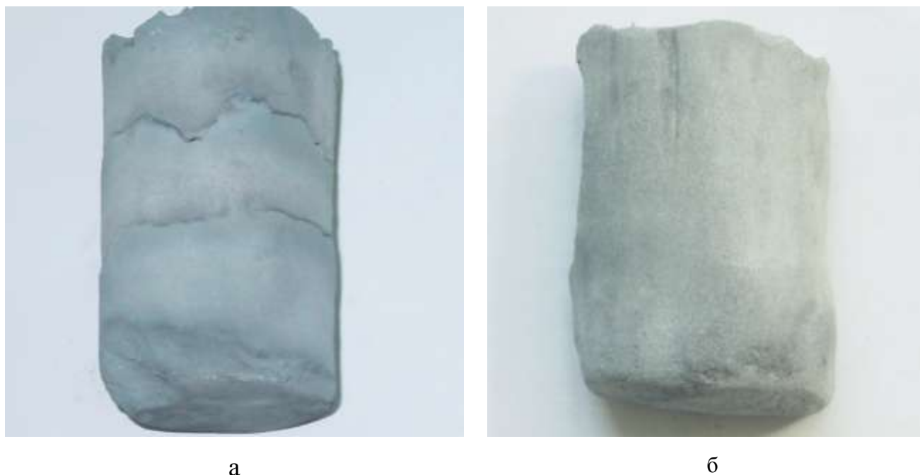
Рисунок 3.11 – Фотографии продукта горения ферросиликоалюминия в азоте без добавок (а) и с добавкой 0,3 мас.% топазового концентрата (б),
