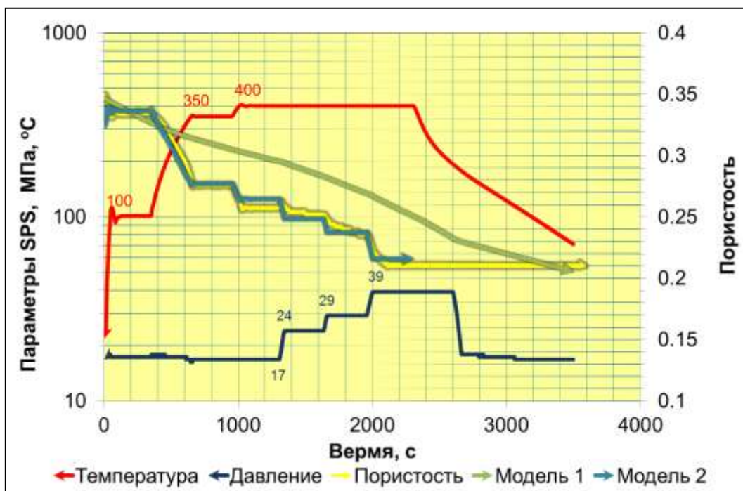
Рисунок 3.30 – Экспериментальное и модельное описание хода кривой изменения пористости композита (65%АМг6+15%В 4 С+20%W) с немонотонным изменением режимов СПС
