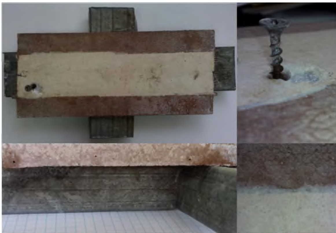
Рис. 7.8 Фотографии внешнего вида образца разработанной комплектной системы на основе стекло-магнезиальных листов после 2 лет хранения во влажных условиях
