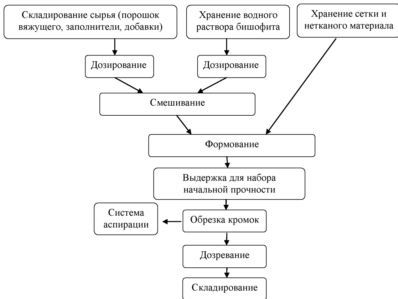
Рис. 7.1 Технологическая схема производства стекло-магнезиальных листов
