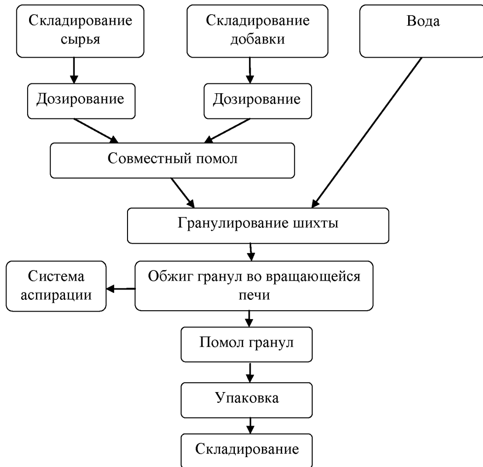
Рис. 5.15. Технологическая схема производства порошков магниальных вяжущих с добавками-интенсификаторами
