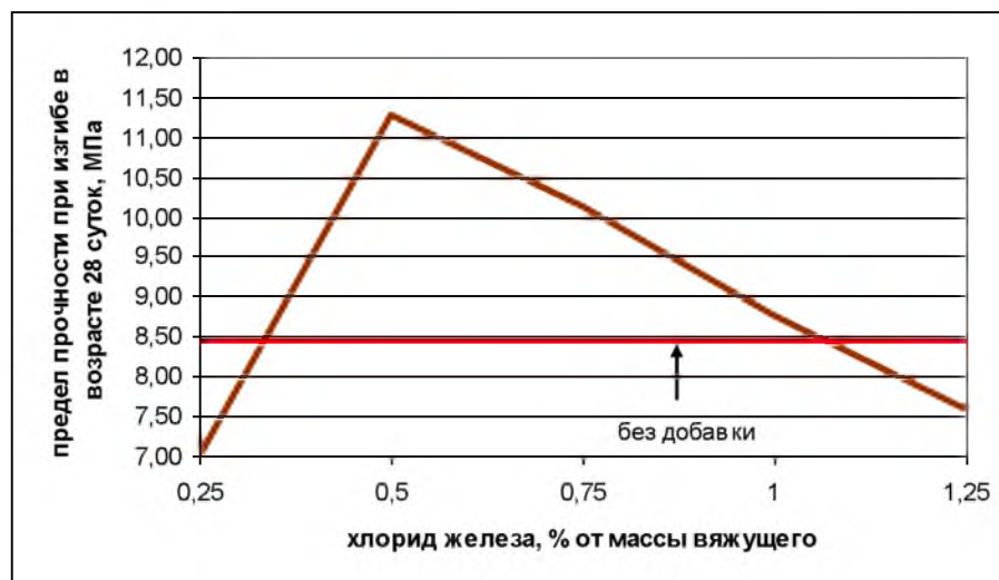
Рис. 7.4 Прочность стекло-магнезиальных листов при изгибе в зависимости от количества добавки хлорида железа
