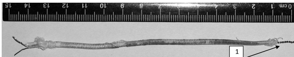
Рисунок 4.2 – Термопара из сплава "хромель–коппель". 1–точка спайки разнородных металлов
