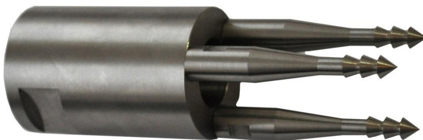
Рисунок 3.17 – Волновод – инструмент «Тройная елочка»
