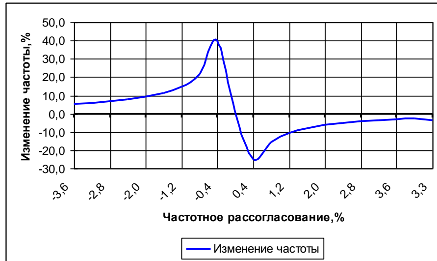
Рисунок 3.8 – Частотно–фазовая характеристика предложенной системы ФАПЧ
