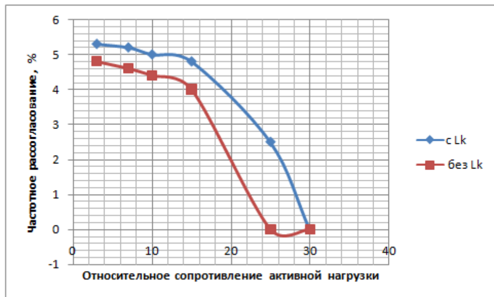
Рисунок 2.9 – Фазово–частотные характеристики акустической системы при различной величине нагрузки с учетом дополнительной индуктивности
