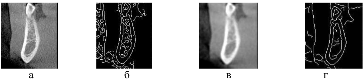
Рисунок 1.25 – Применение фильтра Гаусса с целью подавления шумов: а – исходное изображение; б – результат применения фильтра Кэнни к исходному изображению; в – результат применения фильтра Гаусса к исходному изображению; г – результат применения фильтра Кэнни после применения фильтра Гаусса к исходному изображению
