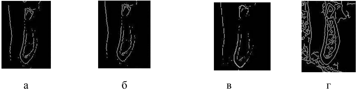
Рисунок 1.22 – Применение различных фильтров с целью определения границ объектов к исходному рентгеновскому изображению на рисунке 1.21:
