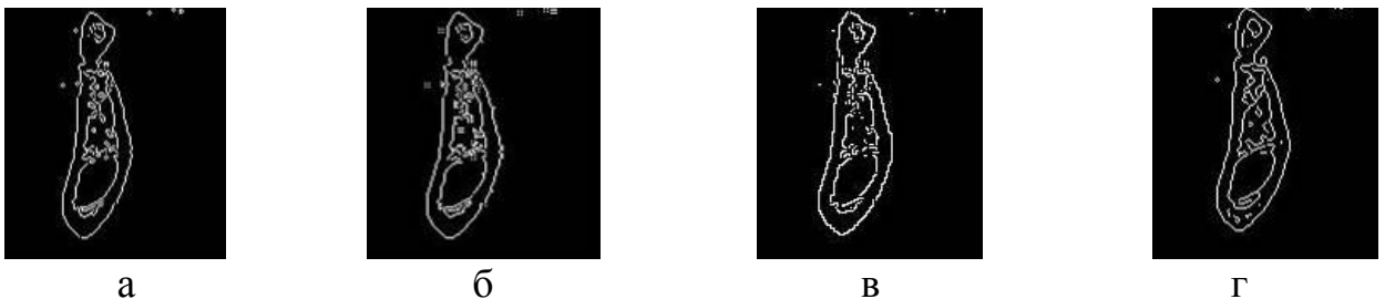
Рисунок 1.24 – Применение различных фильтров к исходному изображению (рисунок 1.23) с целью определения границ костных структур: а – фильтр Собеля; б – фильтр Превитта; в – фильтр Робертса; г – фильтр Кэнни
