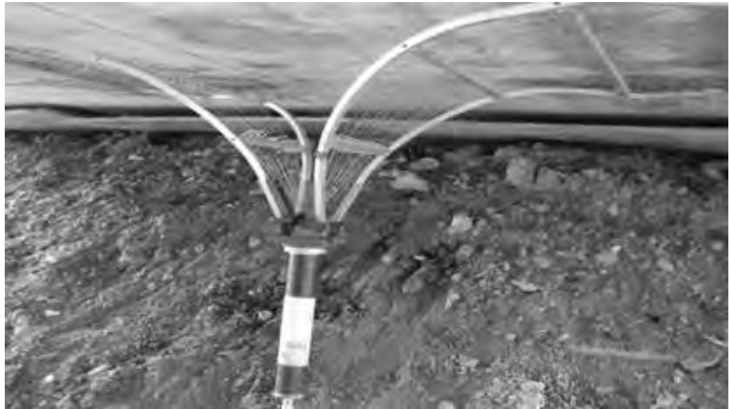
Рис. П.С.1 – Излучающая «на просвет» антенна м-диапазона (струнная)
