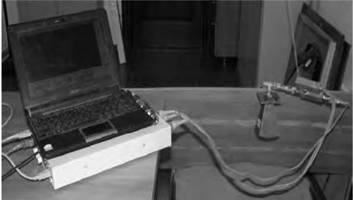
Рис. 3.28 – Определение изотропности подложки из ламината на установке ОБЗОР-103
