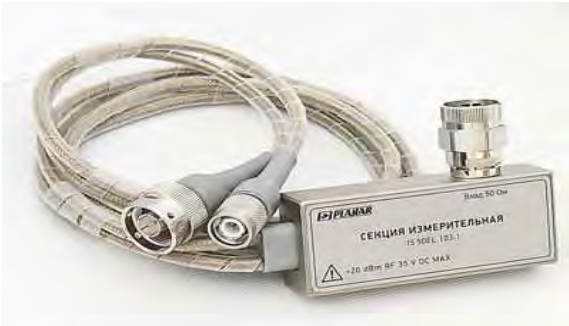
Рис. 2.2а – Измерительная секция PLANAR
