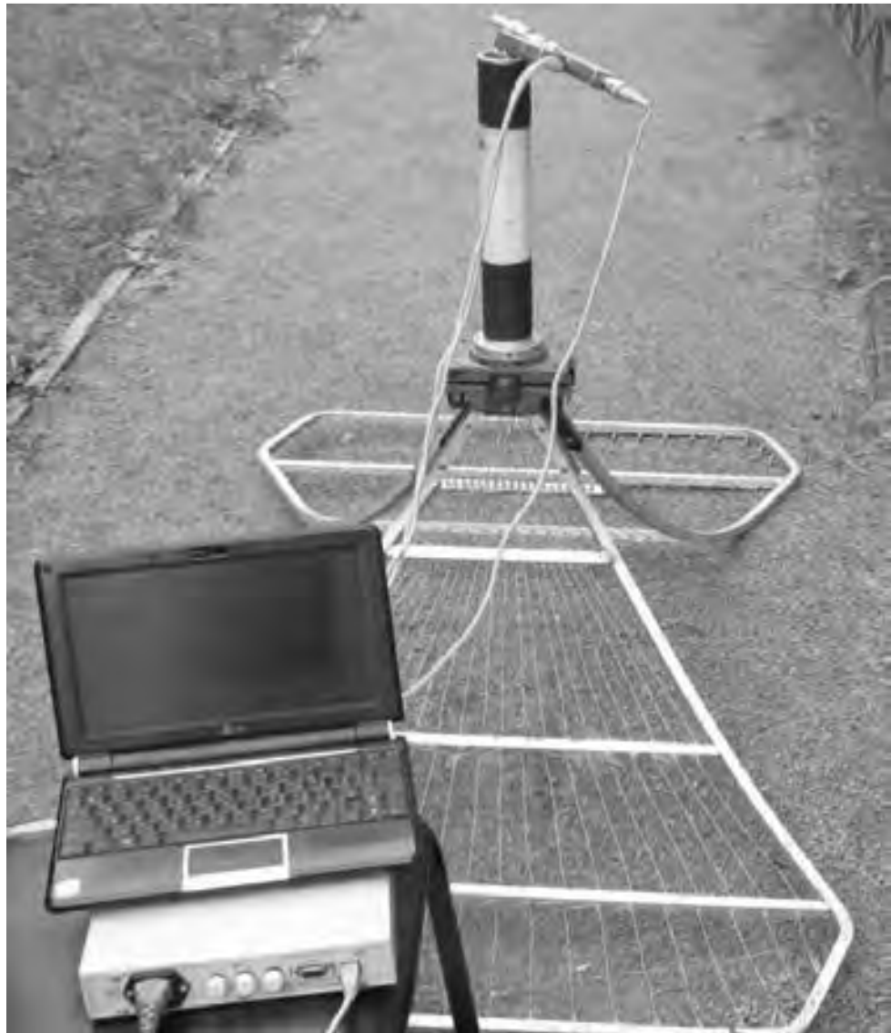
Рис. 3.45 – Установка для измерения параметров тонкопроволочной (струнной) антенны. На переднем плане прибор ОБЗОР-103 (белый), к нему подключён компьютер. На заднем плане проволочная (струнная) антенна: направленный ответвитель с измерительной секцией PLANAR; оголовок антенны с чебышевским плавным переходом внутри; антенное полотно тонкопроволочной (струнной) антенны в виде двух крыльев
