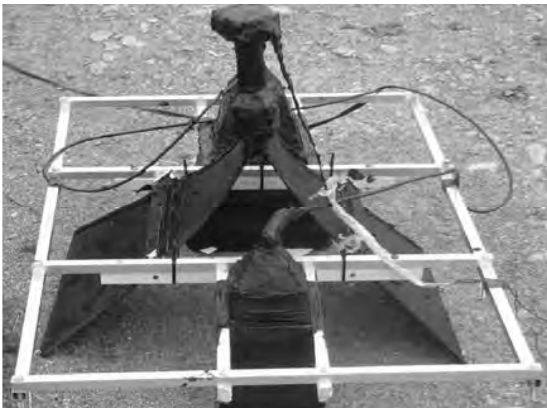
Рис.6.19 – Вид приёмо – передающей части комплекса после работ по гидроизоляции. На переднем плане приёмная антенна дм-диапазона, далее генераторная антенна с ДДРВ генератором (сверху), на заднем плане - приёмная антенна м-диапазона
