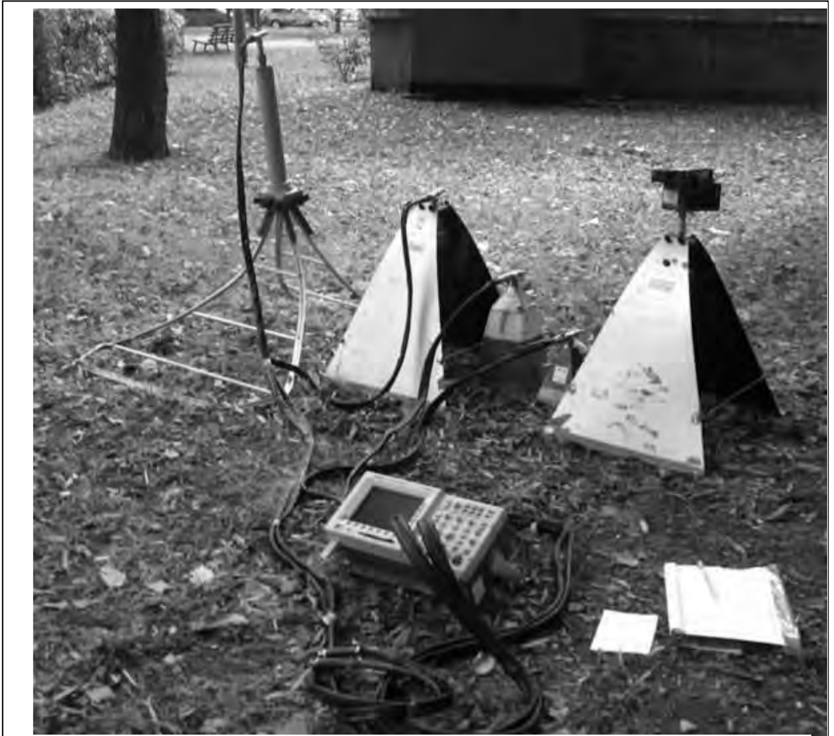
Рис. 2.1 – Общий вид комплекса ЭМИ СШП зондирования с четырьмя типами приёмных антенн: м-, м 1 -, дм-, дм 1 - диапазонов (справа показана генераторная антенна м 1 - диапазона). Приёмник – цифровой осциллограф TDS3054
