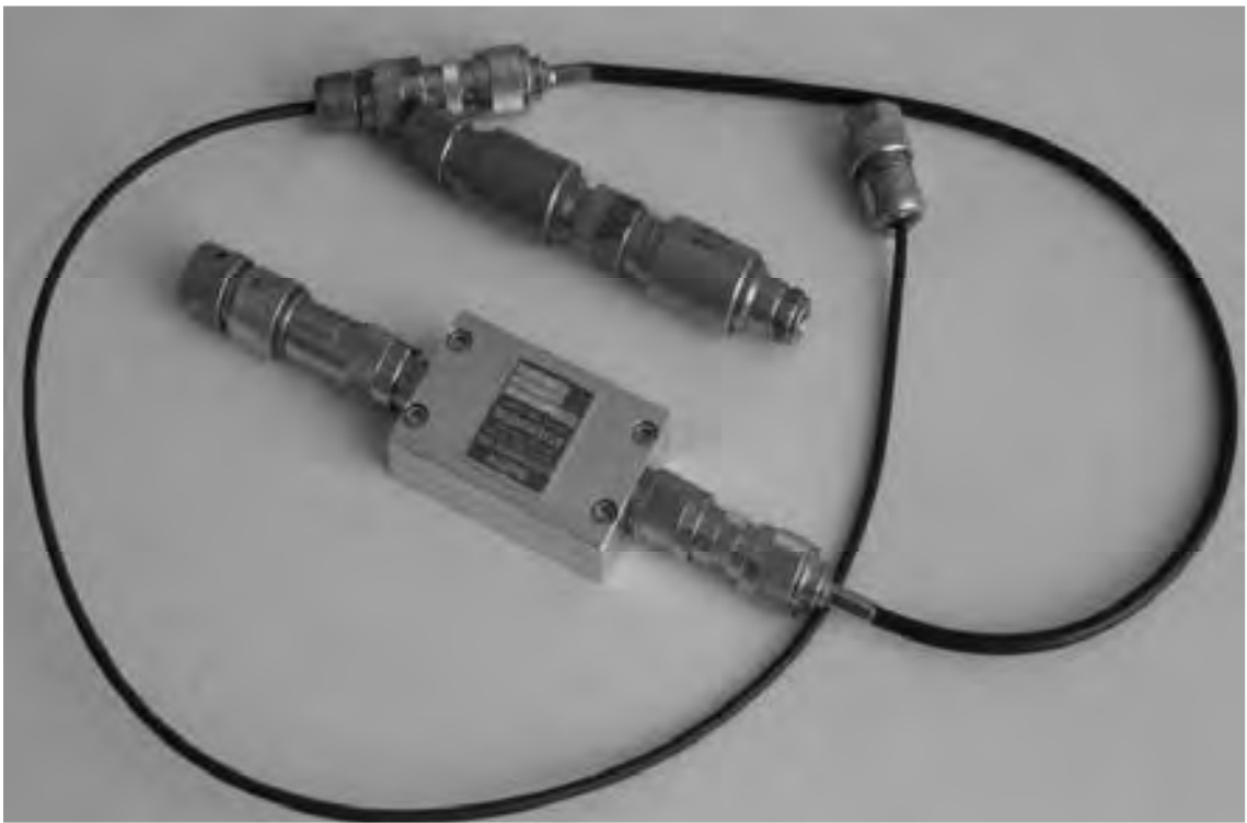
Рис. 2.9 – Вид аттенюатора BARTH ( \Delta f \sim 26 ГГц)
