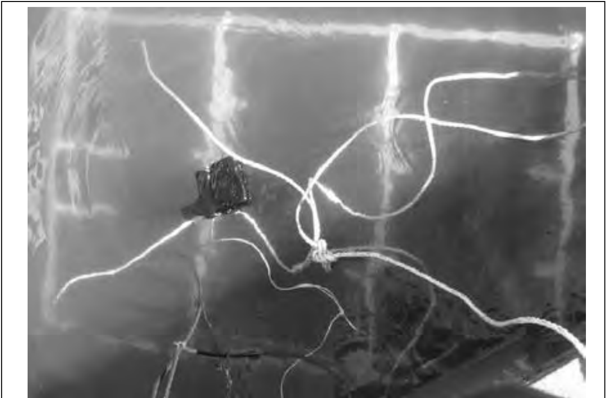
Рис.6.21 – Вид приёмо – передающей части комплекса на глубине 1.5 м. На переднем плане ДДРВ генератор (сверху)
