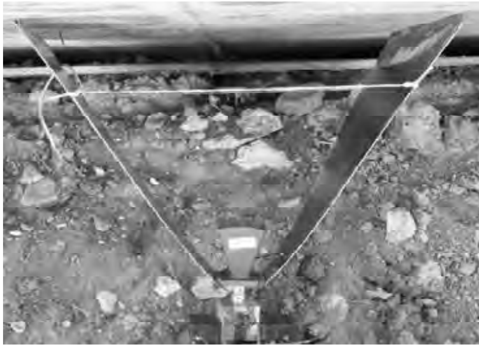
Рис. 3.21 – Излучающая «на просвет» антенна м-диапазона с ДДРВ генератором и аккумулятором питания
