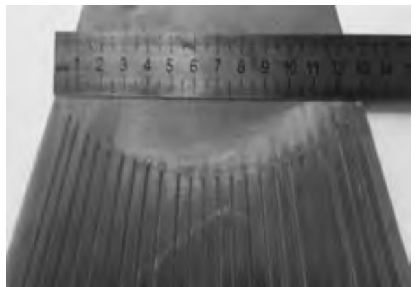
Рис.3.6 – Размеры поперечных сечений токопровода и щели вида (3.15)
