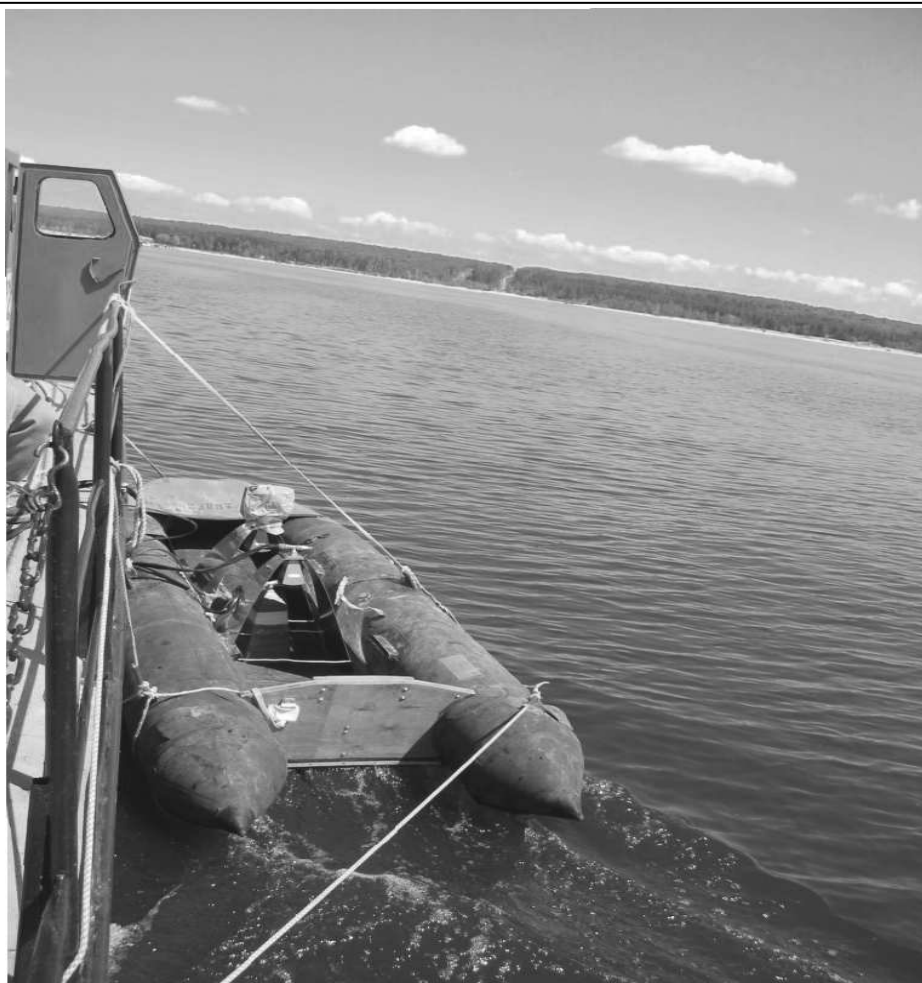
Рис. 5.26 - Размещение приёмо – передающей части комплекса в резиновой лодке за бортом катера
