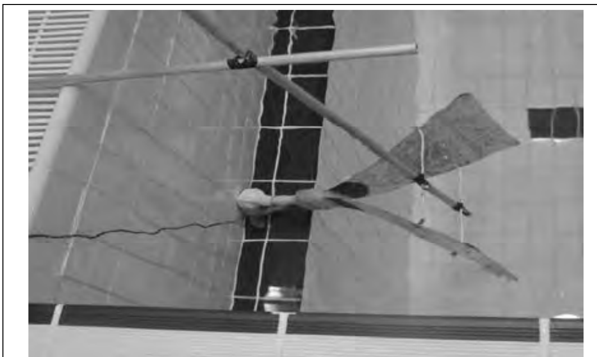
Рис.6.16 - Испытания генератора и антенны в бассейне. Крепящие антенну металлические тяги электрически развязаны с передающими поверхностями антенны
