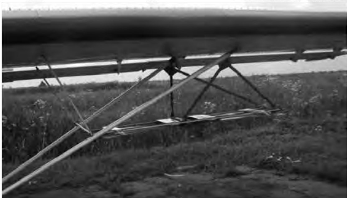
Рис.6.6 - Размещение антенны под крылом самолета STOL-701. Крепящие антенну металлические тяги электрически развязаны с приёмной и передающей поверхностями антенны
