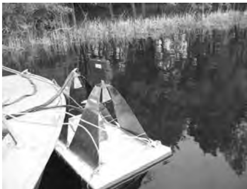
Рис. 5.27 - Размещение приёмо – передающей части комплекса на плоту за бортом катера
