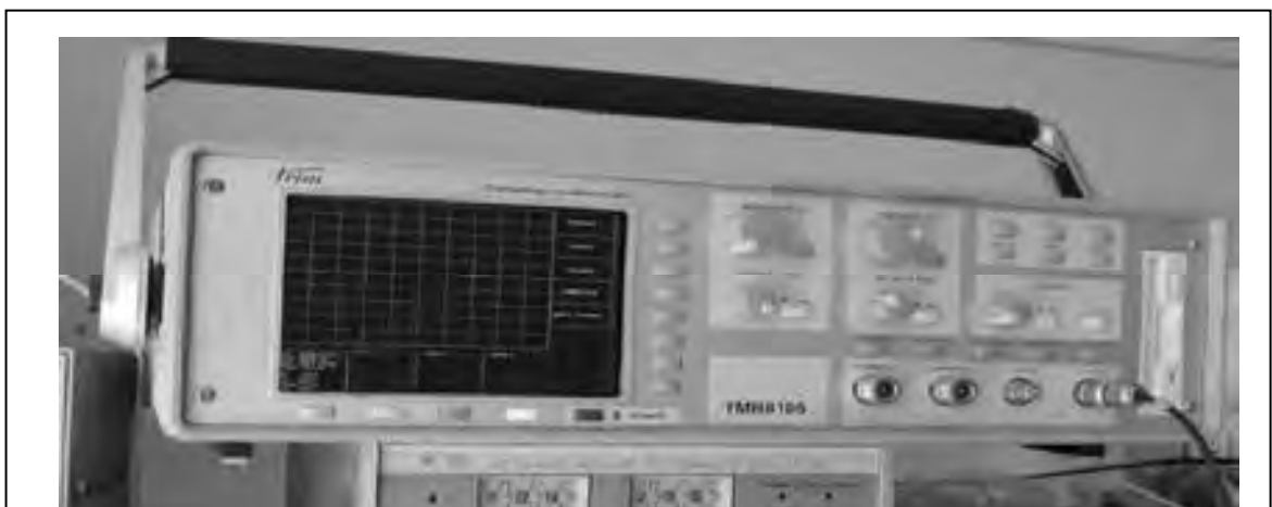
Рис. 2.8 – Вид цифрового стробоскопического осциллографа TMR8105
