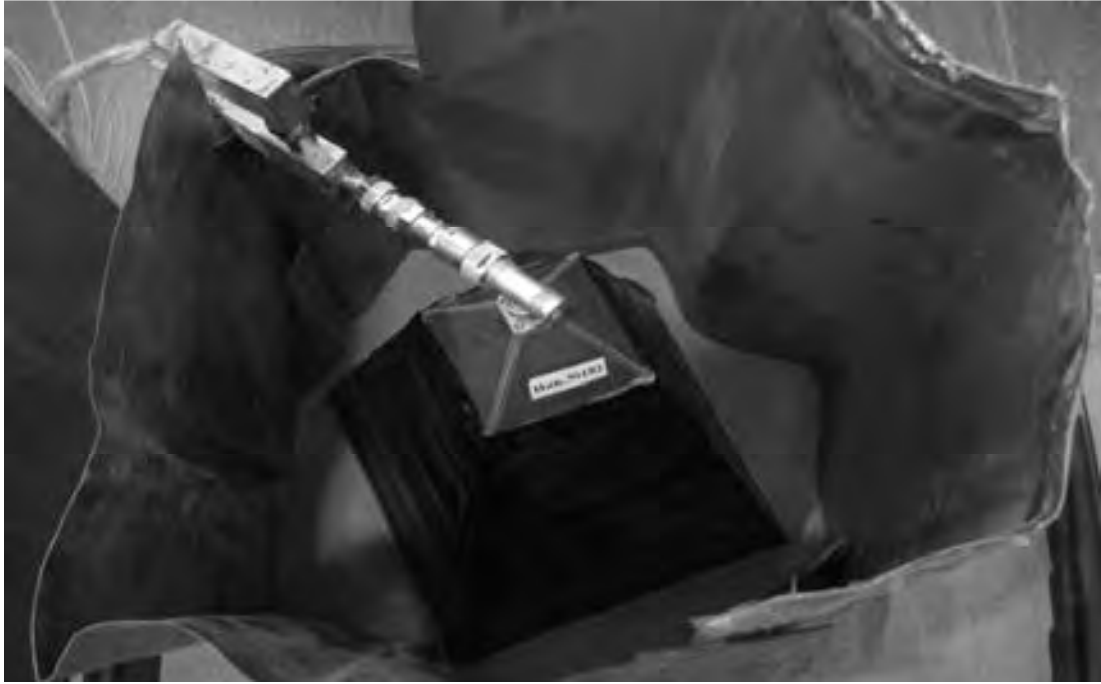
Рис. 3.37 – Проверка работоспособности монопольной антенны дм 1 – диапазона внутри замкнутой по периметру металлической (медной) поверхности путём измерения зависимости K_U от частоты. Измерения на сухом песке
