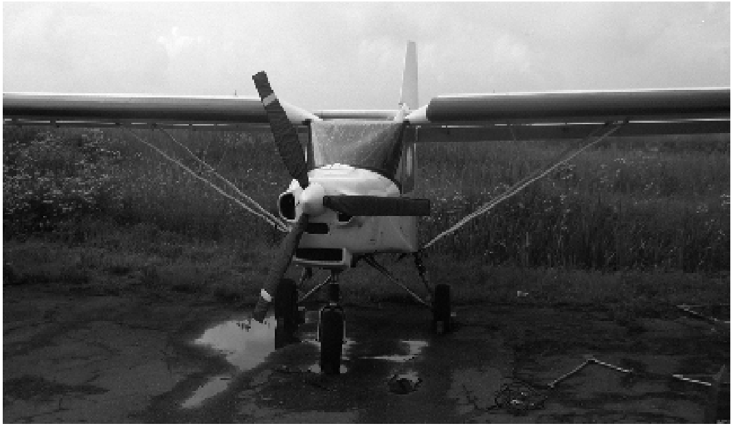
Рис.6.5 - Самолет STOL-701, используемый как летательный аппарат для комплекса подповерхностного ЭМИ СШП зондирования. Технические характеристики STOL-701: размах крыла – 8.23 м; площадь крыла – 11.33 м 2 ; вес (пустой) – 209 кг; дальность – 465 км; крейсерская скорость - 140 км / ч; скорость сваливания – 46.5 км / ч
