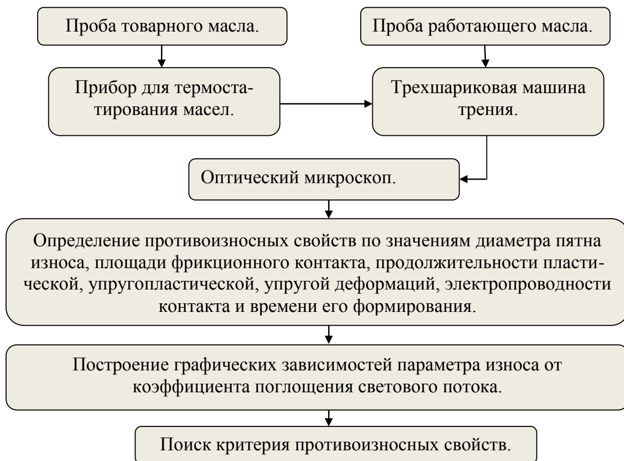
Рисунок 2.8 – Блок-схема контроля противоизносных свойств трансмиссионных масел
