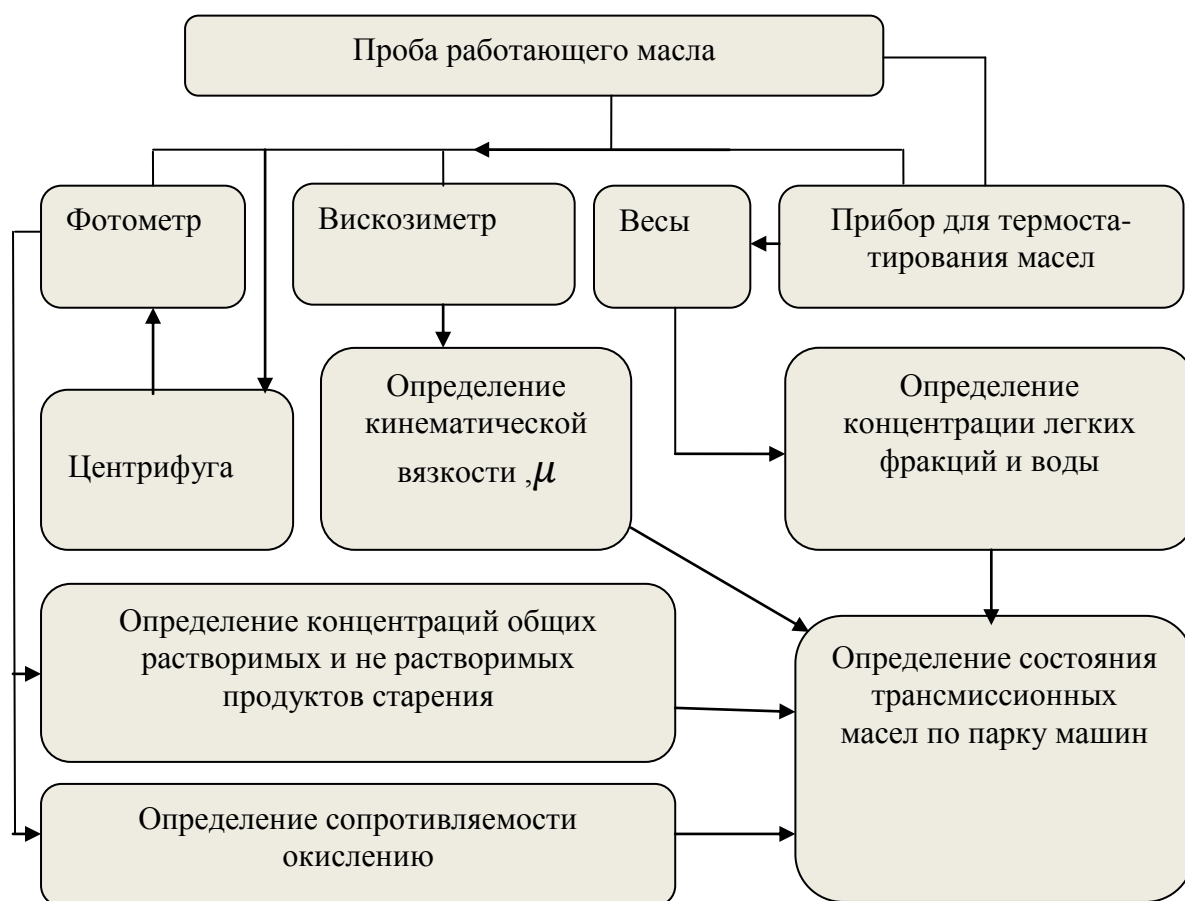
Рисунок 2.7 – Блок-схема методики контроля состояния работающих трансмиссионных масел
