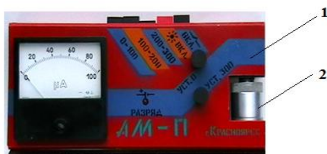
Рисунок 2.1 – Фотометрическое устройство [86]: 1 – измерительный блок; 2 – фотометрическая кювета
