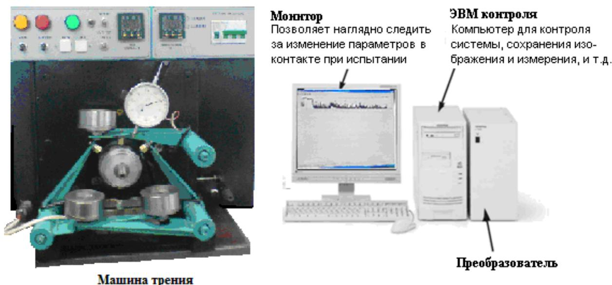
Рисунок 2.4 – Трёхшариковая машина трения
