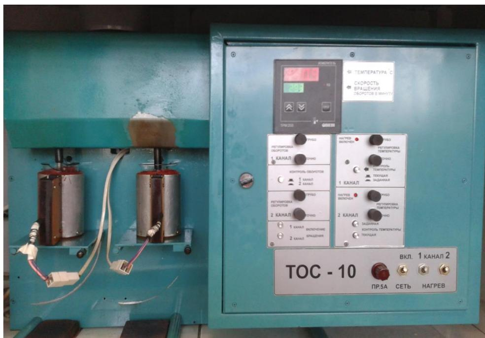
Рисунок 2.3 –Прибор для определения термоокислительной стабильности смазочных масел.
