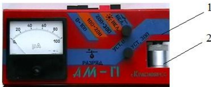
Рисунок 2.1 – Фотометрическое устройство: 1 – блок измерения; 2 - фотометрическая кювета.
