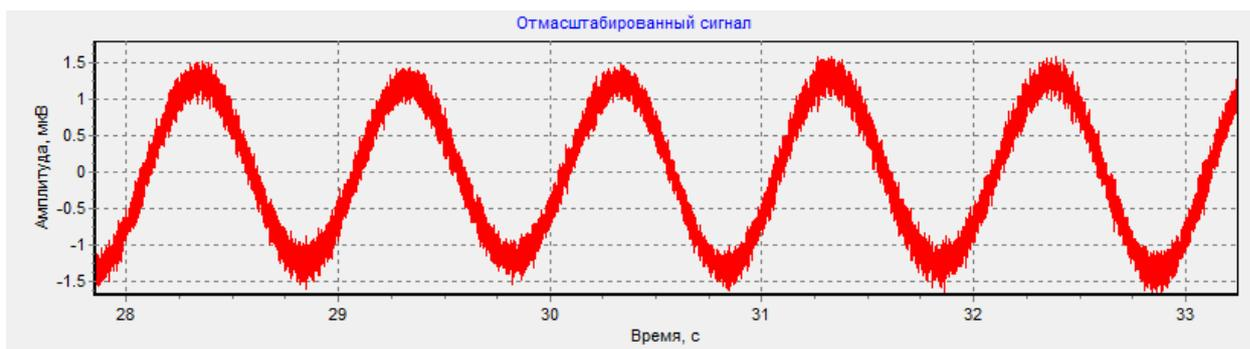
Рисунок 2.2.4 – Синусоидальный сигнал, среднеквадратическое значение 1 мкВ, частота 1 Гц
