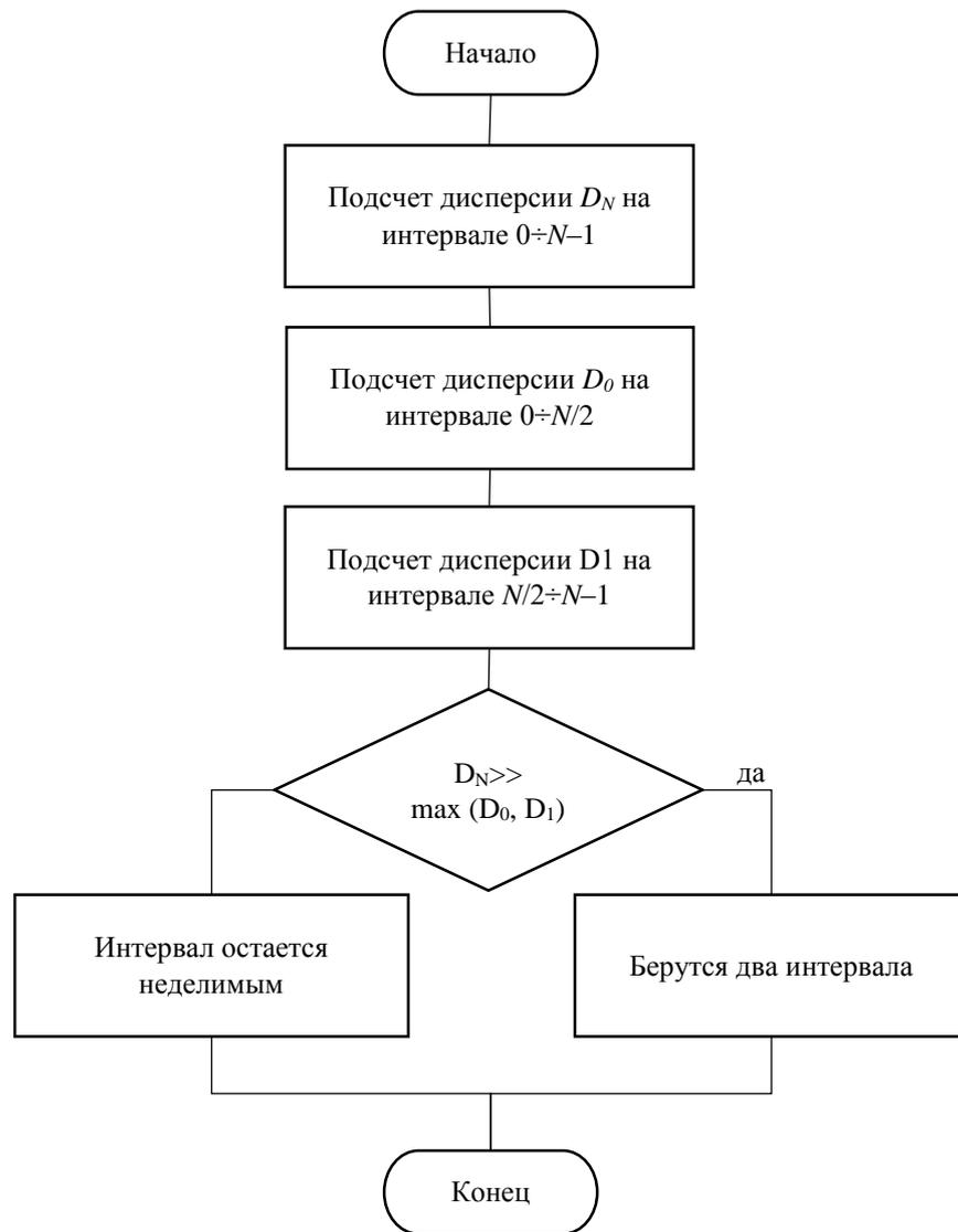
Рисунок 3.1.1 – Блок-схема алгоритма проверки гипотез
