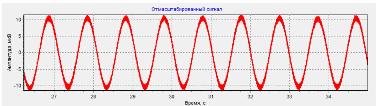
Рисунок 2.2.5 – Синусоидальный сигнал, амплитудное значение 10 мкВ, частота 1 Гц
