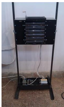
в – 30 кВт галогеновый нагреватель площадочного типа
