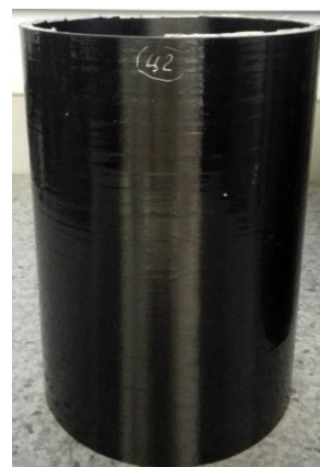
Изделие №2 (Ц2) с 9-ю дефектами, 3 из которых расположены на глубине 1,64мм, 3 на глубине 4,0 мм и 3 дефекта на глубине 4,7 мм
