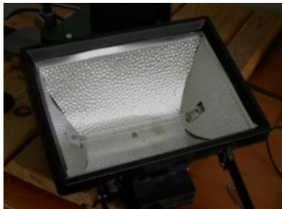
a – Галогеновые лампы мощностью по 1 кВт каждая
