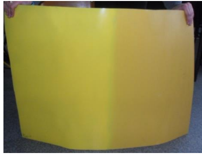
Рисунок 3.10 – Цилиндрические стандартные образцы №3 и №4 из стали С345Т толщиной 1 и 2 мм (слева-глянцевая акриловая краска желтого цвета, справа – матовая акриловая краска желтого цвета)
