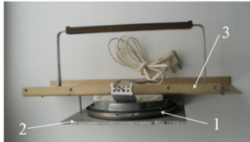
г - контактный нагрев площадочным резистивным нагревателем мощностью 1,5 кВт
