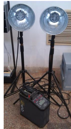
б – Импульсные ксеноновые лампы вспышки мощностью 3,2 кДж
