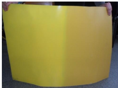
а - цилиндрический стандартный образец №3 толщиной 1 мм (слева-глянцевая акриловая краска желтого цвета, справа – матовая акриловая краска желтого цвета)
