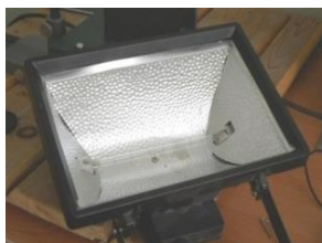
б - оптический нагрев галогенной лампы мощностью 1 кВт
