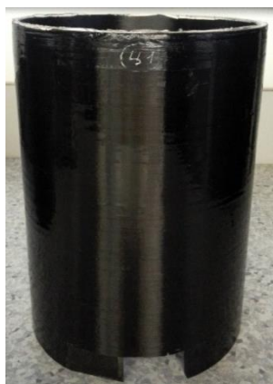
Изделие №1 (Ц1) с 9-ю дефектами, 3 из которых расположены на глубине 1,64мм, 3 на глубине 4,0 мм и 3 дефекта на глубине 4,7 мм
