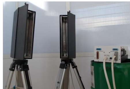
г – Специализированный источник нагрева на галогеновых лампах общей мощность 2×6 кВт
