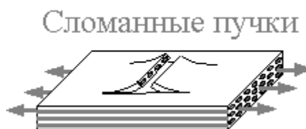
Рис. 1.3. Дефект типа «сломанные пучки»
