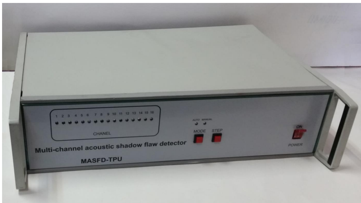
Рис. 3.35. Внешний вид многоканального малоракурсного акустического теневого дефектоскопа «Multi-channel acoustic shadow flaw detector»
