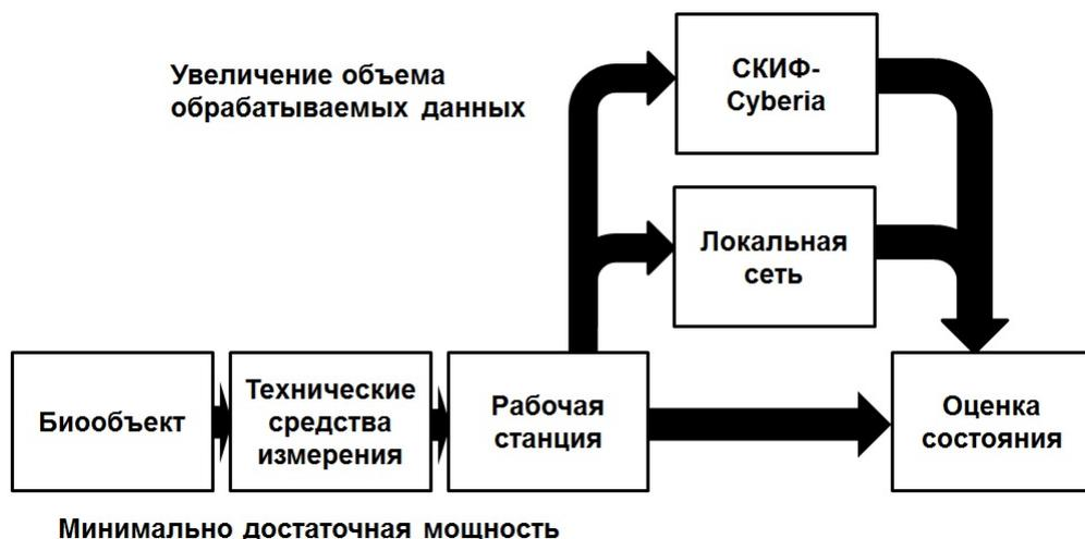
Рис. 2.6. Масштабирование вычислительной нагрузки в системе.
