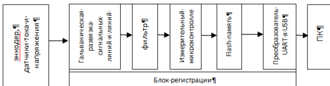
Рисунок 2 - Структура блока регистрации АПК для контроля механических параметров асинхронных электрических двигателей.
