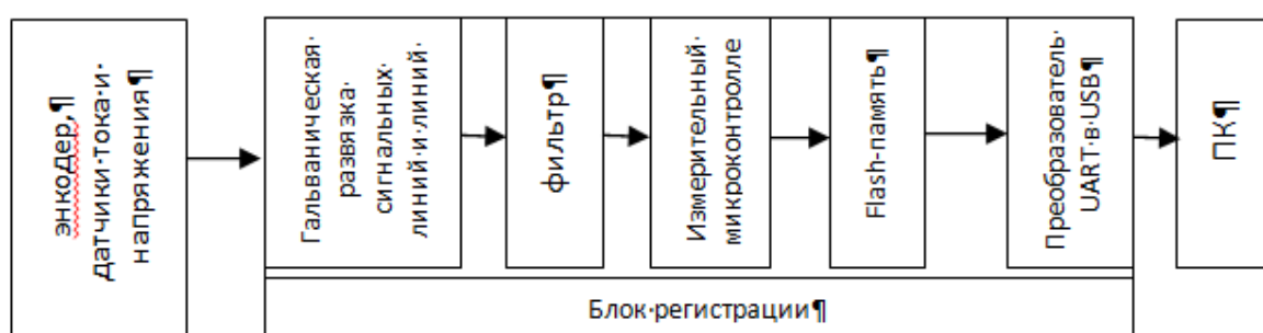
Рисунок 3.3 - Структура блока регистрации АПК для контроля механических параметров асинхронных электрических двигателей.
