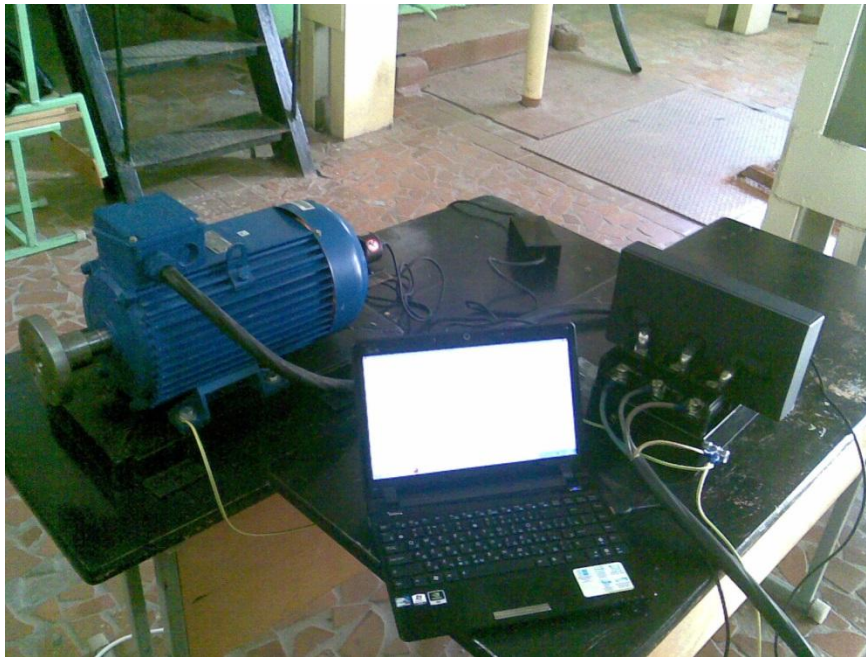
Рисунок 3.1 - АПК для динамического контроля асинхронных электрических двигателей.
