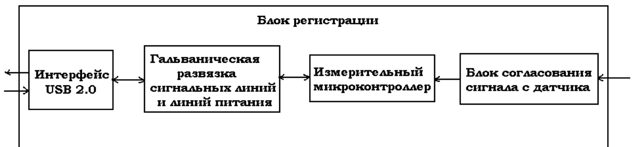
Рисунок 2.9 – Структура блока регистрации аппаратно-программного комплекса
