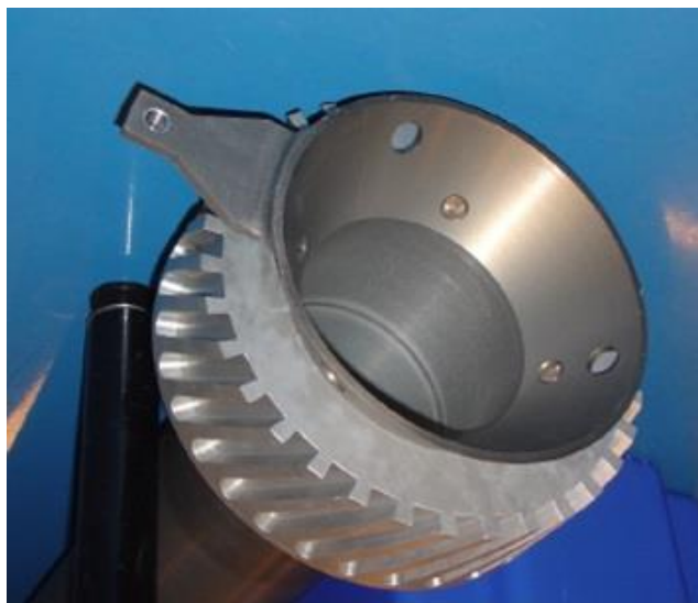
Рис. 1.7. Привод НТЛ кремния на реакторе OPAL [22]
