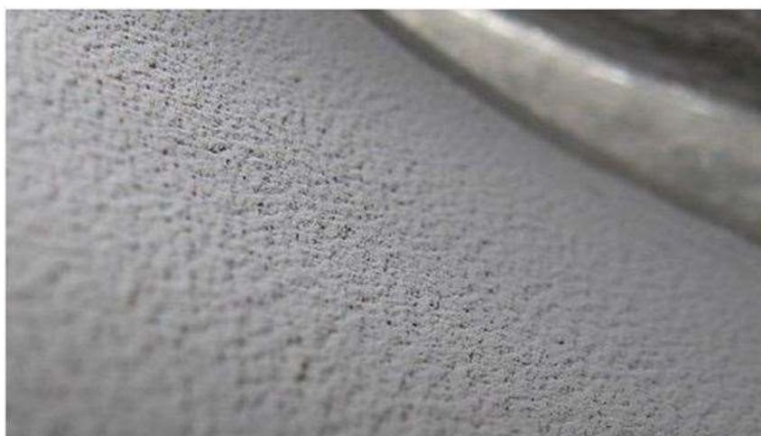
Рисунок 3.22. Фото синтезированного порошкообразного продукта ПДС при свободном истечении плазменной струи.
