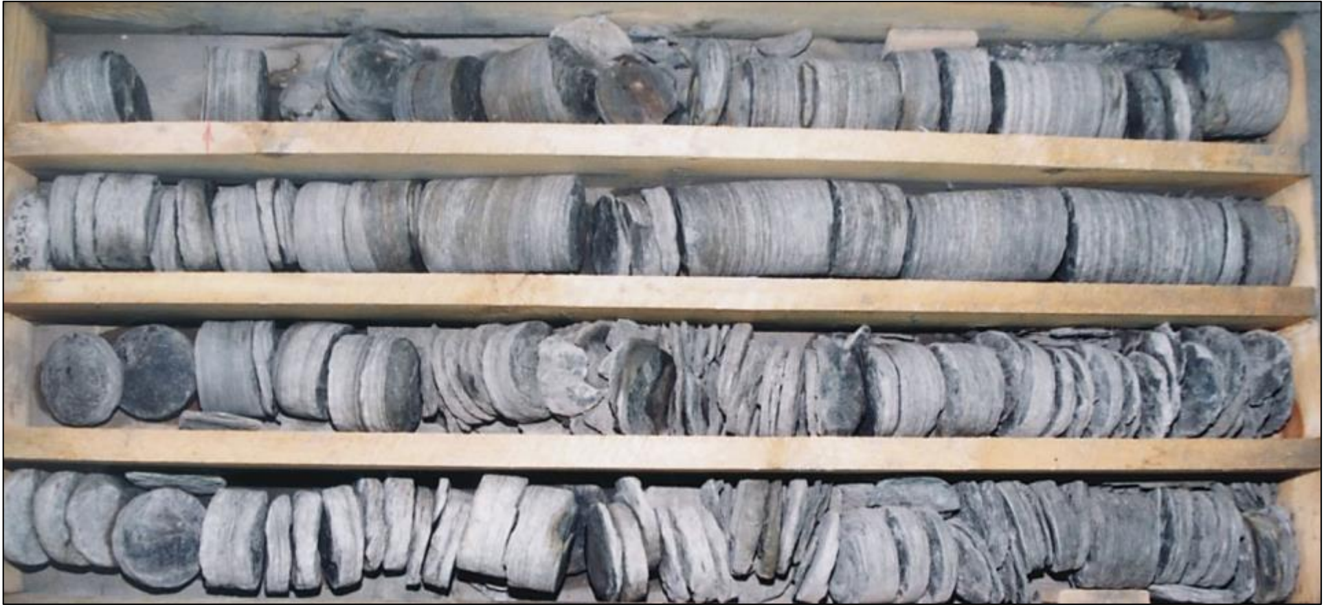
Рисунок 8 – Фотография ящика керн (интервал 2259-2264,5 м), отобранного из скважины 1819 Ем-Ёговского месторождения
