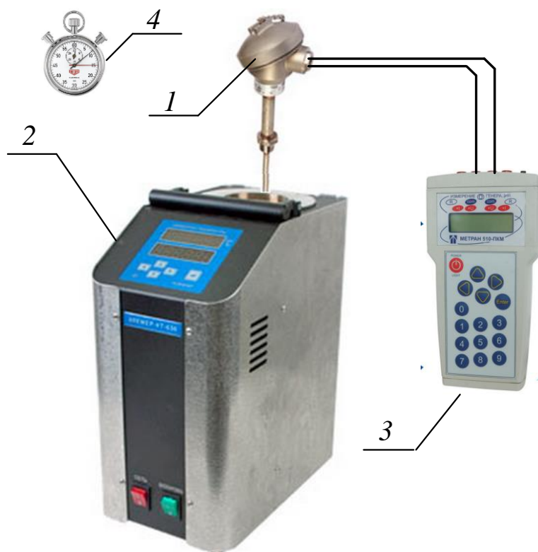
Рисунок 3.6.1. Схема экспериментального стенда: 1 – ТЭП, 2 – сухоблочный калибратор температуры, 3 – многофункциональный калибратор, 4 – секундомер
