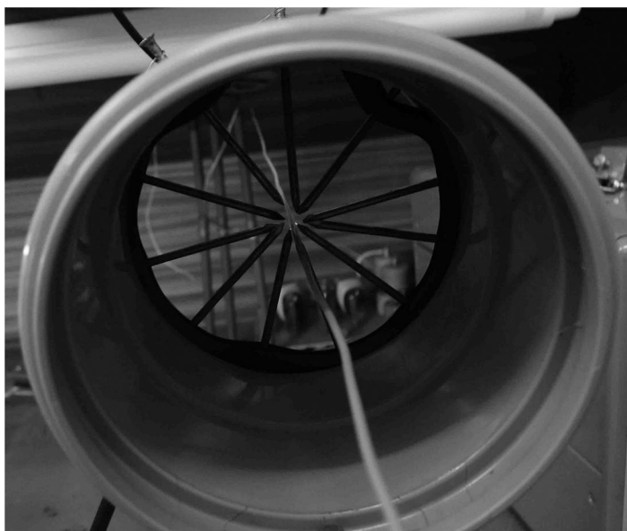
Рисунок 3.3.14. Бесконтактный электрод на переменном напряжении
