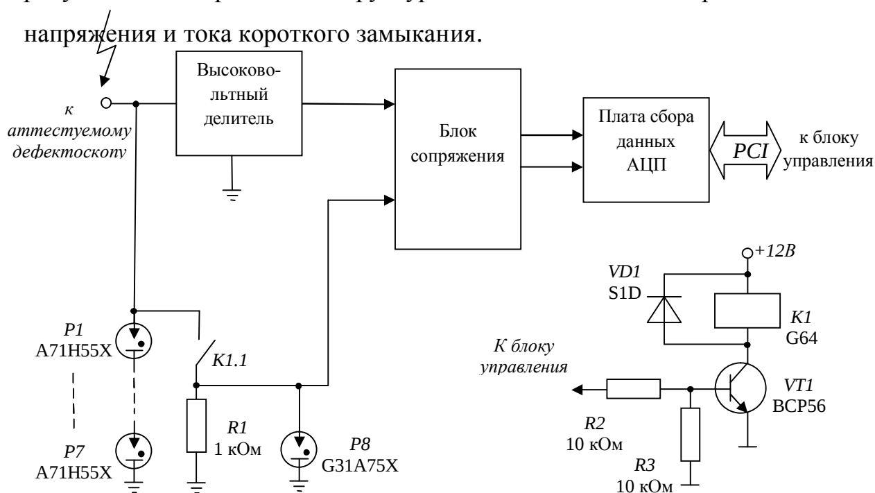
Рисунок 4.2.4 Структурная схема блока измерений высокого напряжения и тока короткого замыкания
