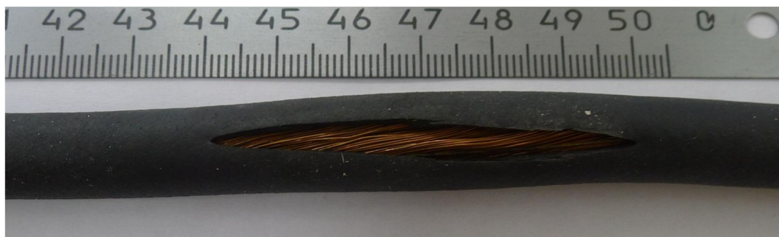
Рисунок 1.2.7 – Недостаточная вулканизация изоляции
