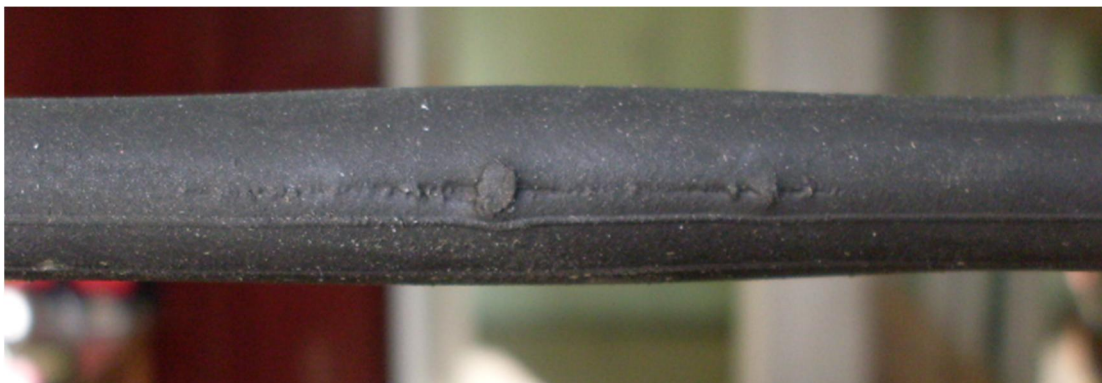
Рисунок 1.2.4 – Шероховатость и растрескивание изоляции
