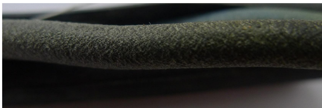
Рисунок 1.2.9 – Повышенная пористость изоляция
