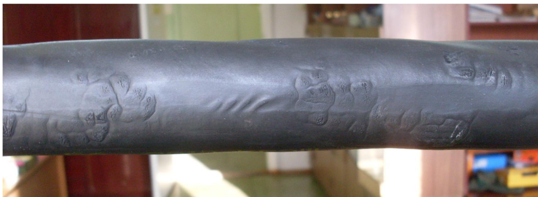
Рисунок 1.2.10 – Неравномерность наружного диаметра, наплывы
