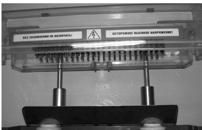
Рисунок 3.2.12 - Конструкция электродного узла и положение контролируемого провода в нем
