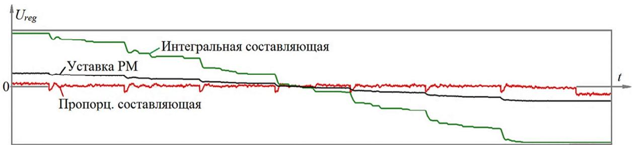
Рис. 4.13. Сигналы регулятора напряжения
