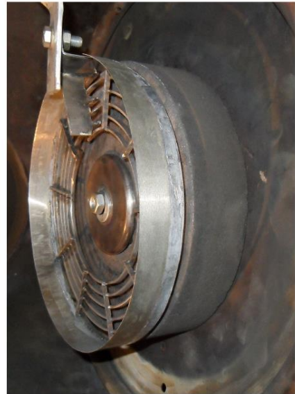
Рисунок 19. Схема и фото диодного узла кольцевого плоского диода: потенциальный электрод (1), заземленный электрод (2), колиммированный цилиндр Фарадея (3), пояс Роговского (4)
