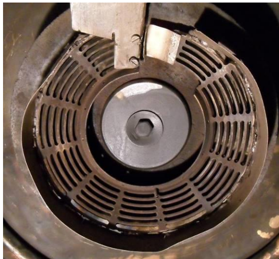
Рисунок 20 Фотография конусного диода и распределение плотности энергии МИП в вертикальном (1) и горизонтальном (2) сечениях в фокусной плоскости
