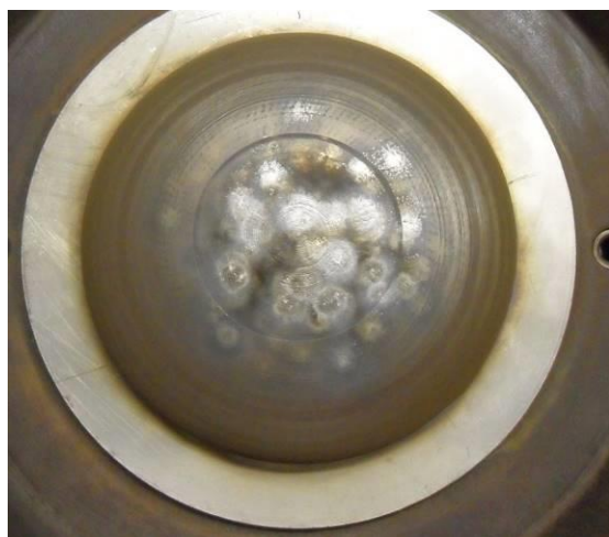
Рисунок 83 Фото электрода основного разрядника и осциллограммы напряжения (1, точки) и тока (2) на выходе ГИН и расчетные значения напряжения (3, линия). Одноимпульсный режим, резистивная нагрузка
