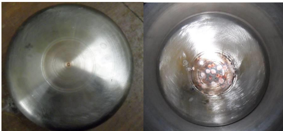
Рисунок 87 Фото электрода основного разрядника с киритовой вставкой до и после работы в разряднике
