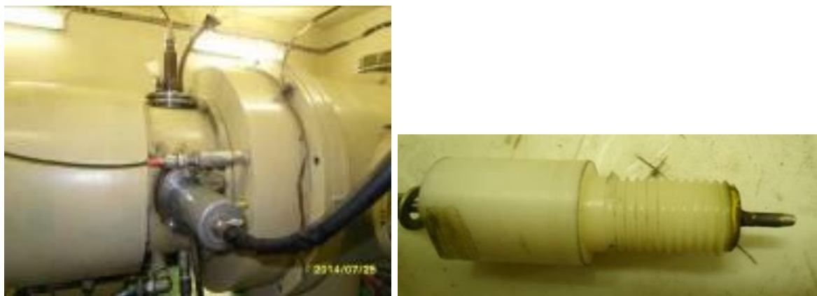
Рисунок 93 Фото блока формирования импульса запуска и управляющего электрода тригatrona
