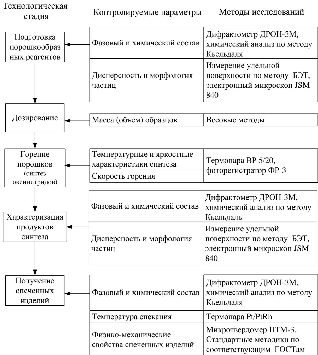
Рисунок 4.1 – Технологическая схема получения оксинитридной керамики
