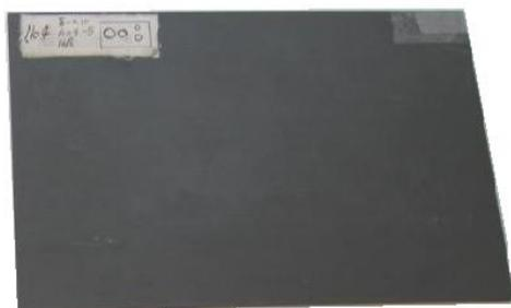
Рисунок 5.40 - Стандартный образец из углепластика
