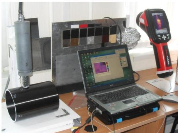
Рисунок 5.35 - УЗ стимуляция цилиндрического изделия из углепластика
