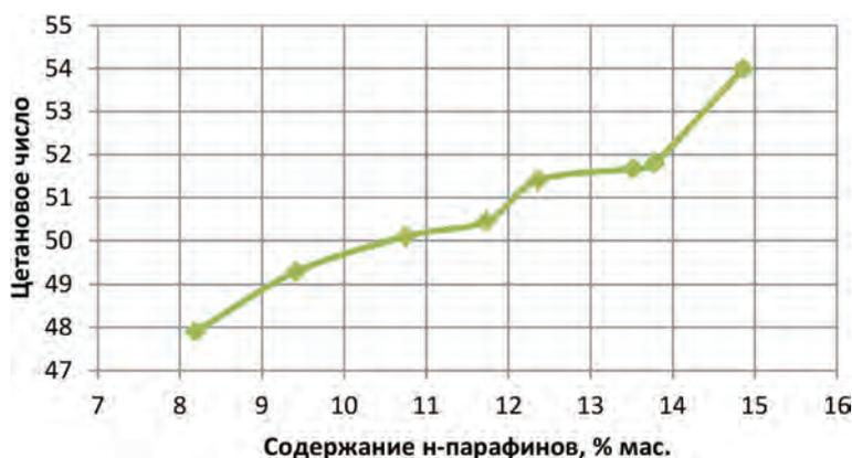
**Рис. 1.** Зависимость ЦЧ от содержания n-парафинов
