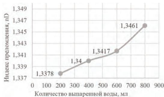
Рис. 4. Показатель преломления от объема выпаренной воды при выпаривании
