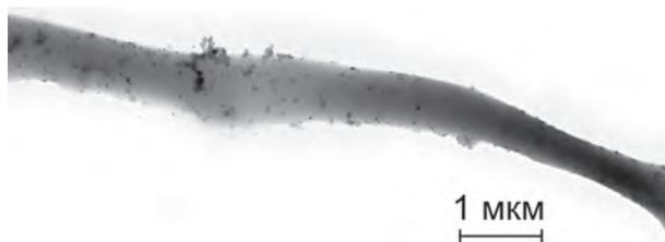
Рис. 1. Фрагмент полипропиленового волокна с закрепленными на его поверхности оксидными наночастицами
