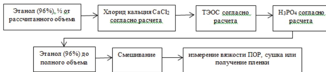
Рис. 1. Схема приготовления ПОР
