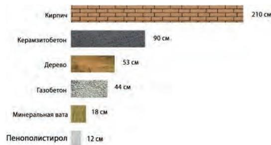
Рис. 1. Схема толщин стен
