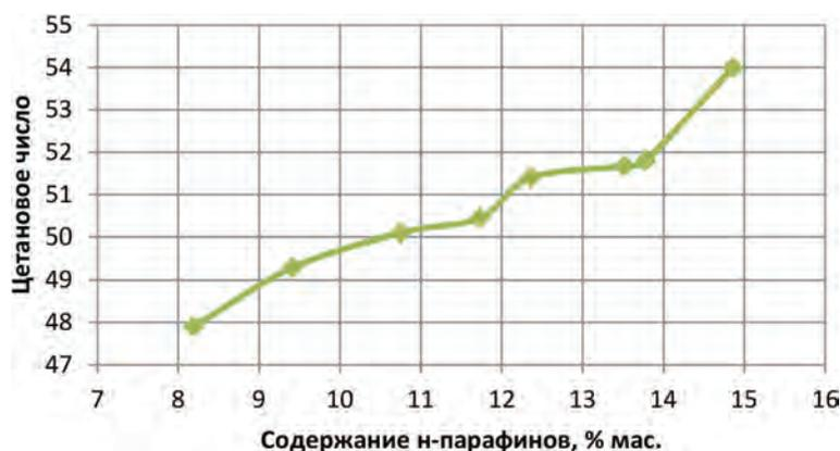
**Рис. 1.** Зависимость ЦЧ от содержания n-парафинов
