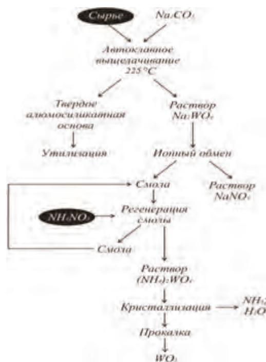
Рис. 1. Принципиальная схема получения оксида вольфрама из отходов оловянного производства
