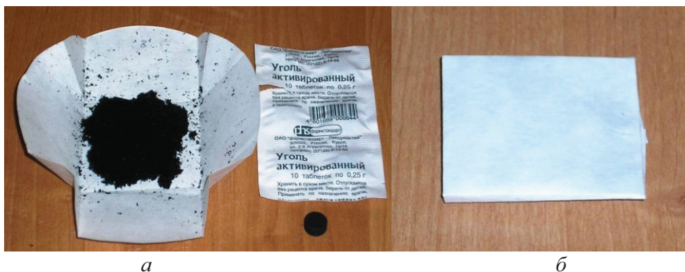
Рис. 5. Раневая повязка в виде сорбционной подушечки: а) графеновая вата из НСГ на фильтровальной бумаге; б) раневая повязка в форме адсорбционной подушечки
