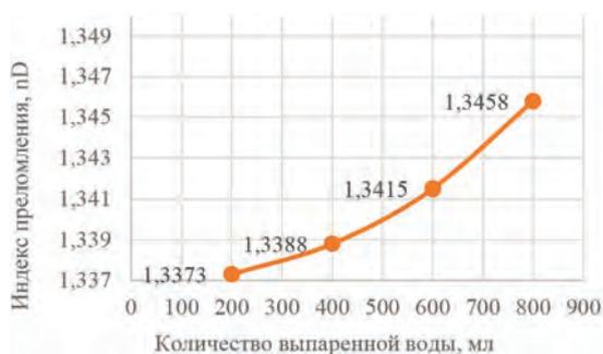
Рис. 3. Показатель преломления от объема выпаренной воды при выпаривании
