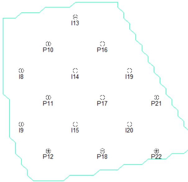
Рисунок 27. Схема разработки обрезаемого участка
