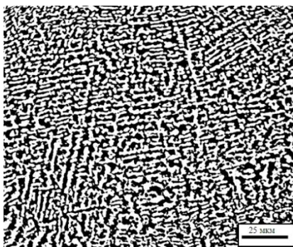
Рисунок 2 - Структура слоя, наплавленного смесью \text{Cr}_3\text{C}_2 + \text{Cr} + \text{TiC} при токе пучка I = 40\text{mA} W = 5,60 \text{ кДж/см}^2
