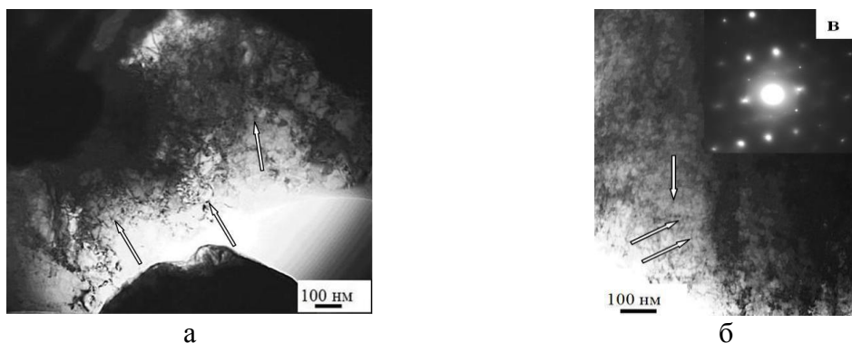
Рисунок 3 - Электронно-микроскопическое изображение нанокристаллической структуры в слое, стрелками указаны наноразмерные выделения карбидов титана (а, б); микроэлектронограмма от наноразмерного карбида TiC (в)
