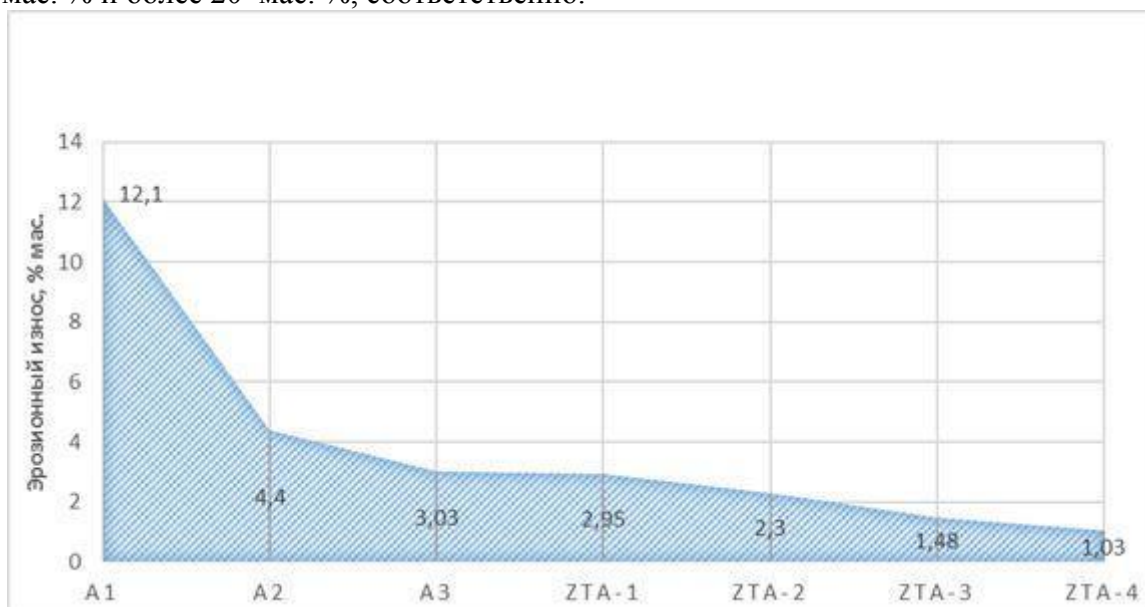
Рисунок 1 - Эрозионный износ образцов керамики различных составов
