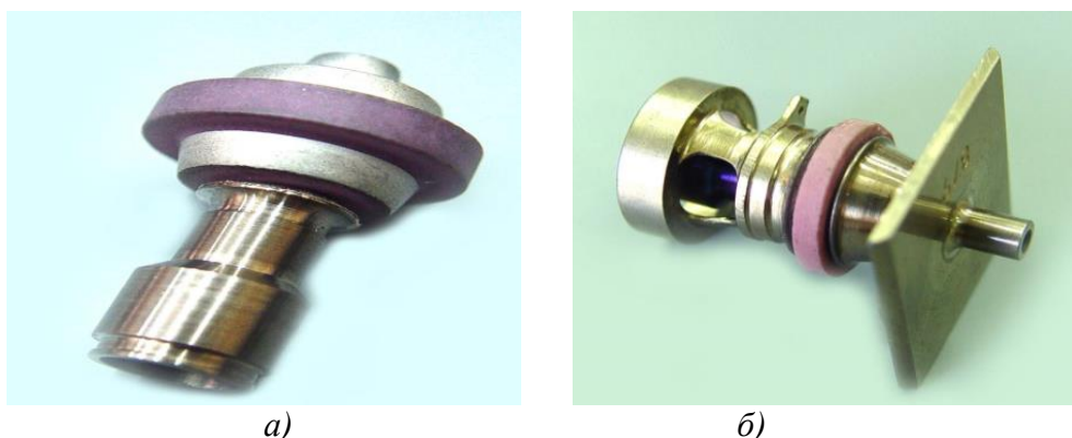
Рисунок 4 – Образцы из циркония Э110 с керамикой, спаянный припоем ПСр72: а) образец после пайки; б) образец-цоколь
