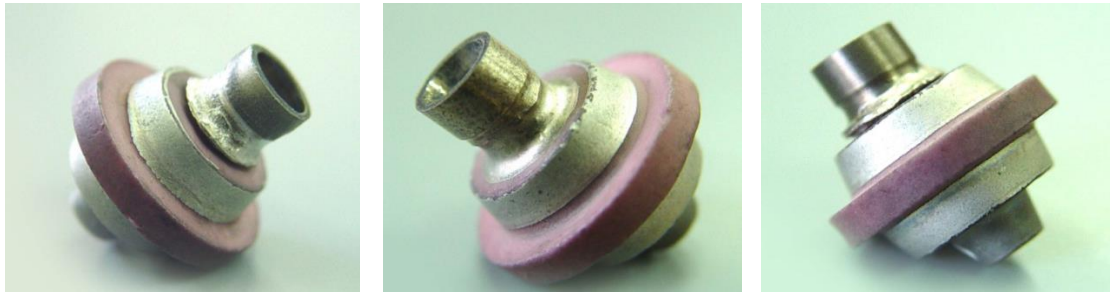
Рисунок 3 – Образцы из циркония Э110 с керамикой, спаянные припоем ВПр4
