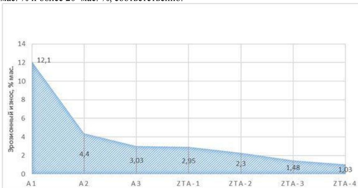
Рисунок 1 - Эрозионный износ образцов керамики различных составов
