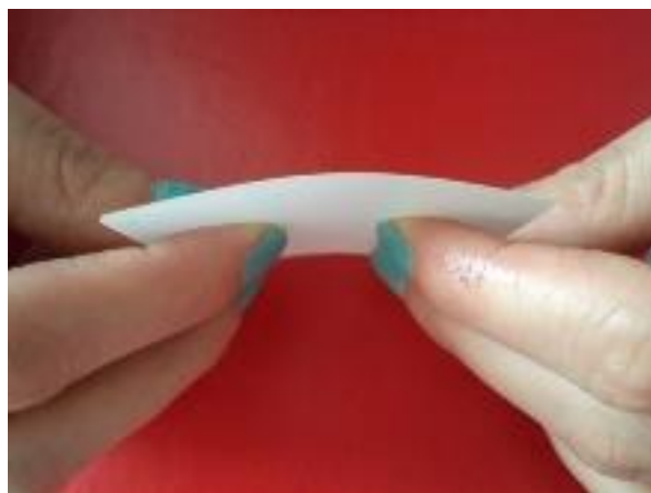
Рисунок 3 - Образец трехслойной керамической пластины
