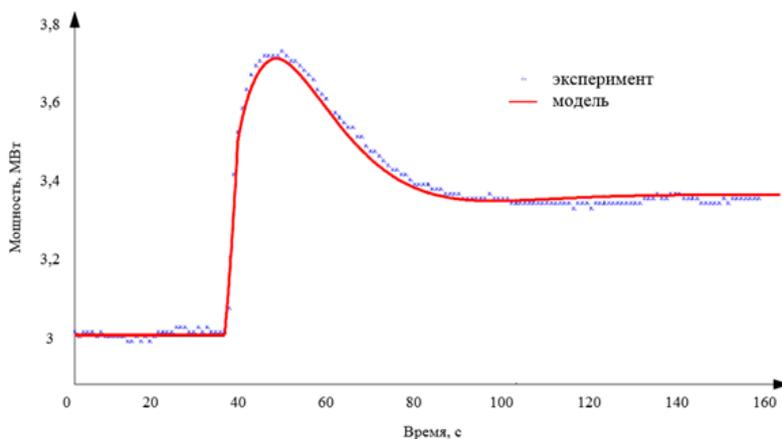
Рисунок 1. Переходный процесс при введении реактивности на уровне мощности 3 МВт
