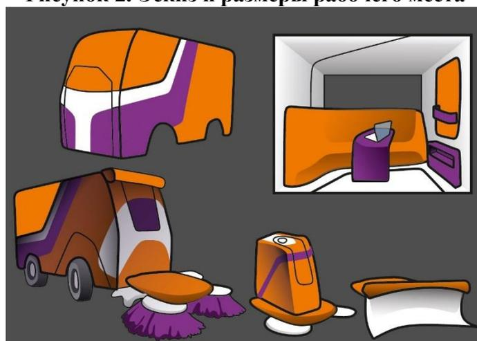
**Рисунок 3. Сменные модули.**
