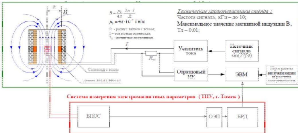
Рисунок 2. Структурная схема стенда для испытания измерительных каналов
