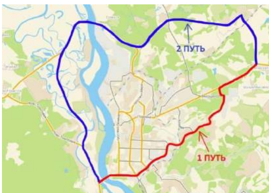
Рис. 2 Изображение автомобильных дорог с учетом строительства левобережной дороги для расчета технико-экономических показателей (вариант 2)
