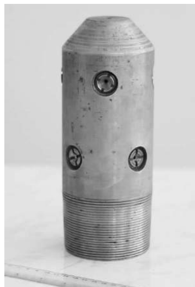
Рис.3 Натурный образец – статическое устройство, диаметр 89 мм
