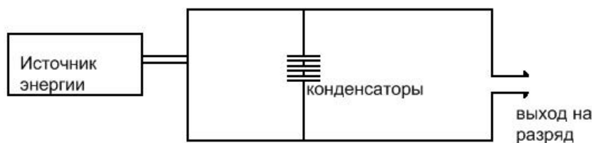
Рис.1 Схема установки плазменно-импульсного воздействия
