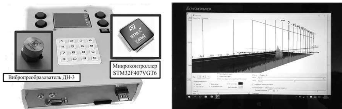
Рис. 2. Внешний вид портативного устройства (слева), модуль визуализации программного обеспечения на планшетном компьютере (справа)
