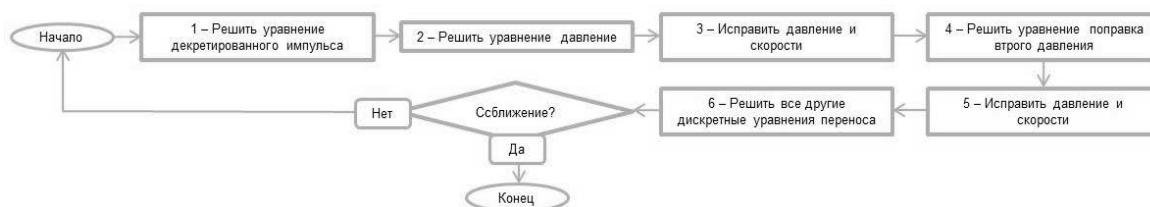
Рис. 2. Блок-схема алгоритма PISO
