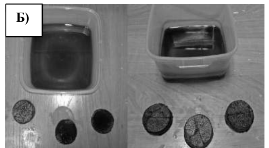
Рисунок 4 – Внешний вид образцов и жидкой среды по истечении 24 часов (слева) и 480 часов (справа): А – при 75 °С, Б – при 90 °С
