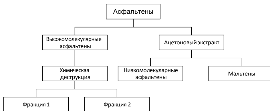
Рис. Общая схема получения исследуемых компонентов из исходных асфальтенов
