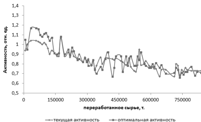
Рис. 1 Мониторинг работы промышленной установки каталитического риформинга бензинов
