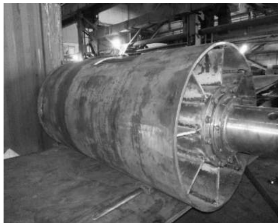
Рис.2. Шнеко-аккумулирующий буровой снаряд Ø750 мм. Акт о внедрении №736 от 26 сентября 2014г. ОАО «Алмазы Анабара»
