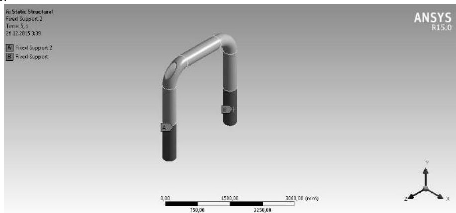
Рис. 3. Жесткое закрепление на концах участка трубопровода
