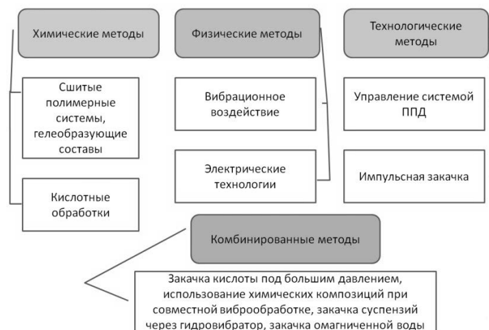
Рис.1 Технологии повышения и выравнивания профиля приемистости нагнетательных скважин
