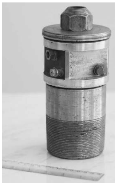
Рис.2 Натурный образец – роторное устройство, диаметр 100 мм
