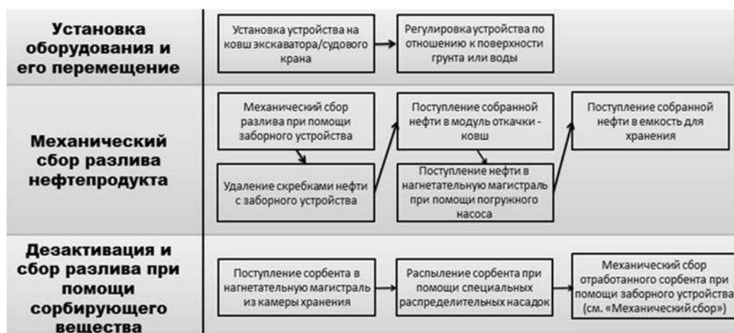
Рис. 2. Схема работы универсальной установки, предназначенной для ликвидации разливов нефтепродуктов.
