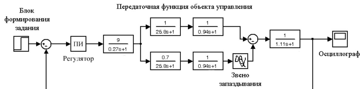
Рис. 1. Модель САР температуры углеводородного конденсата на выходе из кожухотрубного теплообменника
