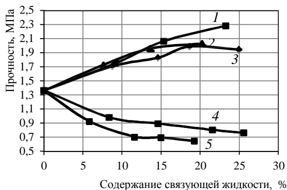
Рис. 1. Зависимость прочности таблеток от содержания связующей жидкости: 1 – 0,1% ПАА, 2 – 0,1% МЦ, 3 – 0,1% КМЦ, 4 – 1% глиоксаль, 5 – глицерин
