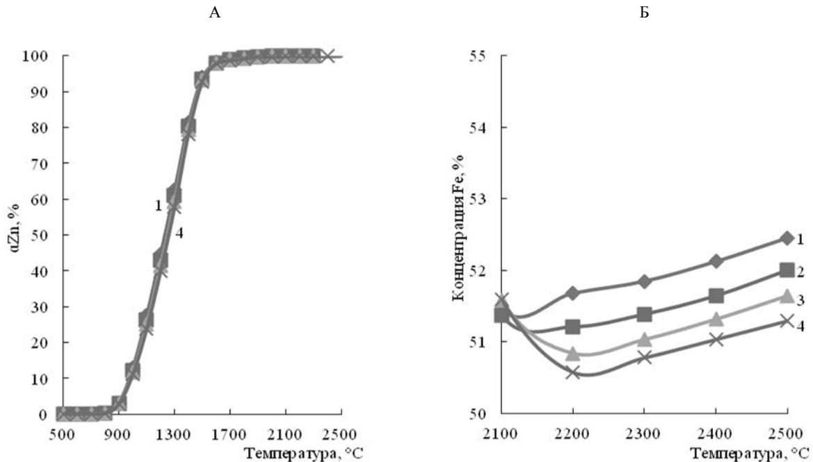
А – степень извлечения цинка в газовую фазу, Б – Концентрация железа в ферросплаве
